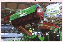
Le système de reprise d'ensilage pour remorques mélangeuses de Strautmann, qui a reçu une médaille d'argent, combine les avantages du système bien connu de la désileuse bloc et de la fraise. L'ensilage est détaché du silo par une plaque avec soin et sans contrainte mécanique. Il est transporté par un tambour d'alimentation muni de segments de vis de convoyage jusqu'à un tapis roulant. L'ensilage en vrac tombe directement sur le tambour d'alimentation lorsque la
