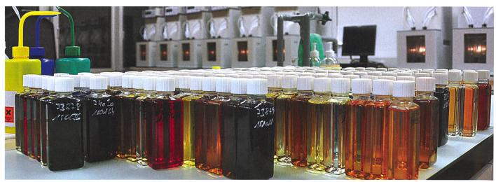
La diversification des huiles augmente sans cesse. Un échantillon de chaque charge de production est prélevé et analysé à Motorex.
