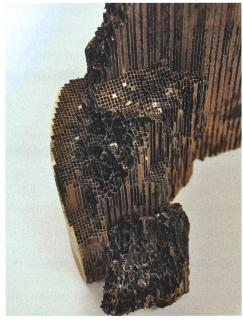
Les filtres à particules saturent rapidement de cendres sulfatées en cas d'utilisation d'une huile inapropriée.
