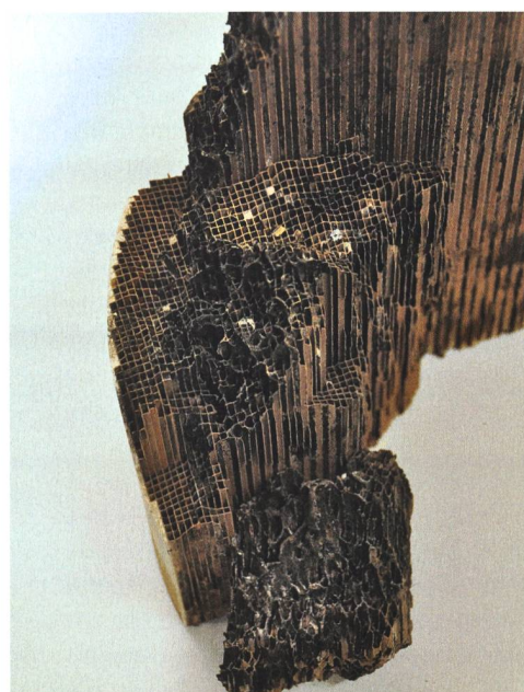
Les filtres à particules saturent rapidement de cendres sulfatées en cas d'utilisation d'une huile inappropriée.
