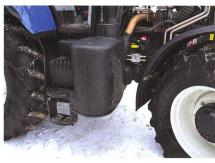
Le catalyseur SCR se trouve en bas, ce qui ne limite pas la visibilité.
