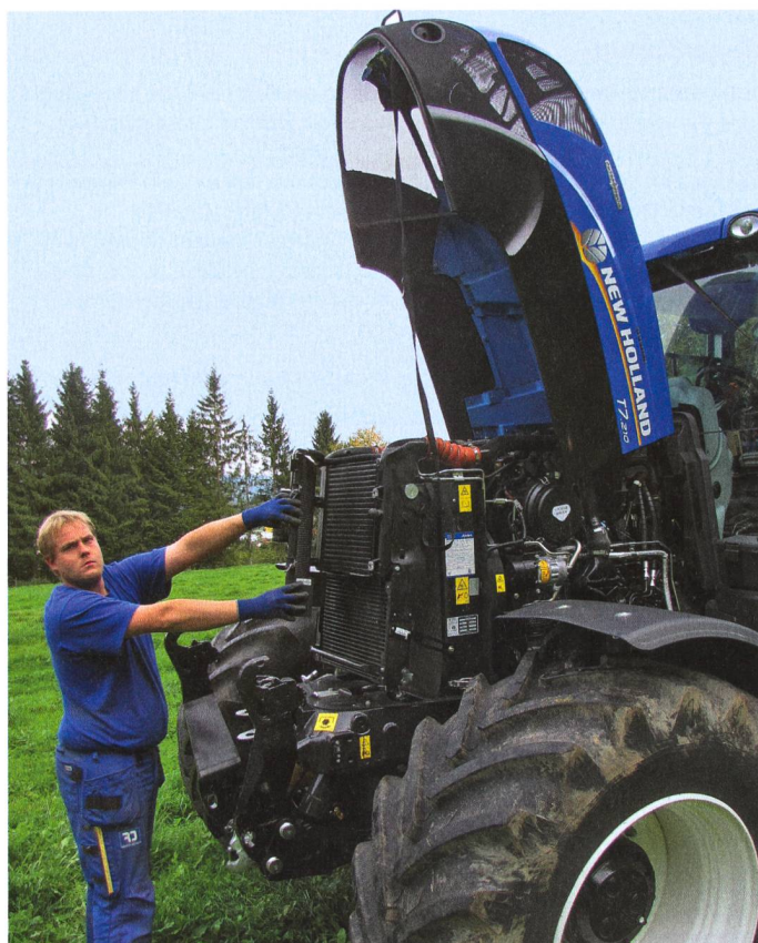
Le capot se relève très haut, et les éléments de refroidissement sont ainsi faciles d'accès.
