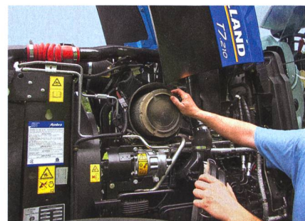
Le filtre à air se situe à une hauteur favorable. Cependant, la conduite passant devant peut rendre son changement quelque peu difficile.
