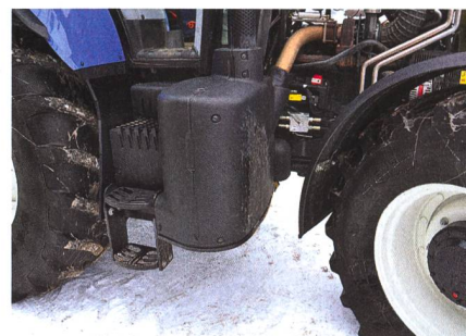
Le catalyseur SCR se trouve en bas, ce qui ne limite pas la visibilité.
