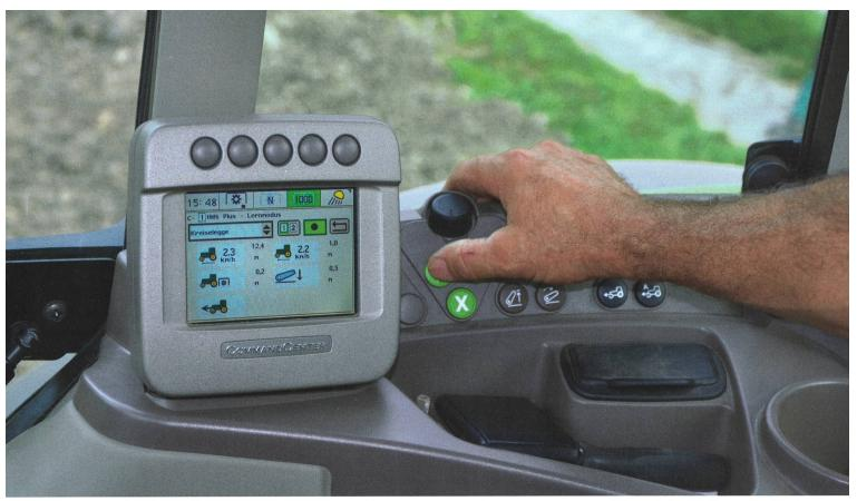
Le guidage automatique par trace, relié à une gestion des retournements en bout de champs, décharge le conducteur afin qu'il puisse se concentrer sur la profondeur de travail du sol, le semis et la surveillance des machines. (Photos: d'usine/Ruedi Hunger)
