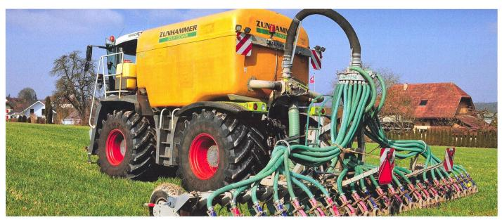
Le véhicule système Claas Xerion de Markus Schneider s'utilise avec un injecteur à disques et une herse à disques compacte. (Photo d'usine)
