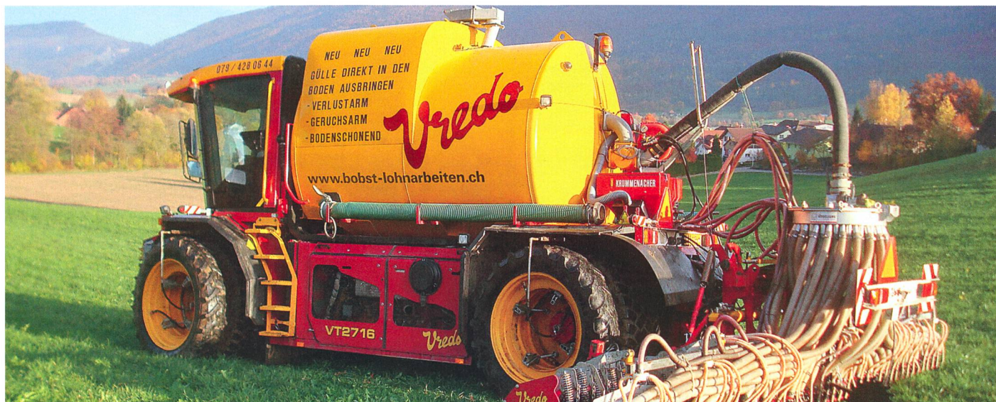
Le porte-outils de type Vredo 2716, utilisé chez Andreas Bobst, délivre une puissance moteur de 270 Ch, et son tank a une capacité de 13 000 litres. (Photo : Beat Schmid)
