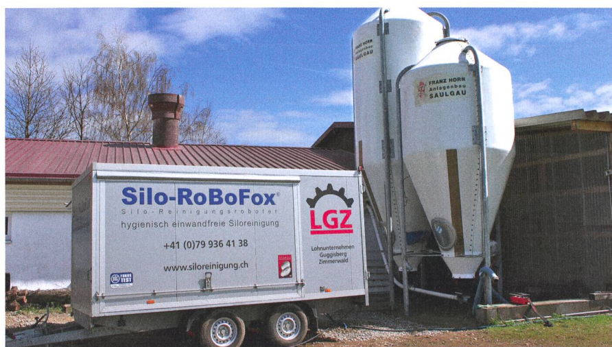
Emballage compact, dans cette remorque, de tout le matériel nécessaire au nettoyage des silos géré par l'informatique et à l'aménagement de l'accès. L'ouverture d'accès est visible sur le silo.
