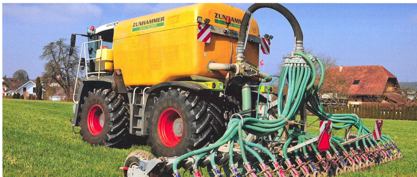
Le véhicule système Claas Xerion de Markus Schneider s'utilise avec un injecteur à disques et une herse à disques compacte. (Photo d'usine)
