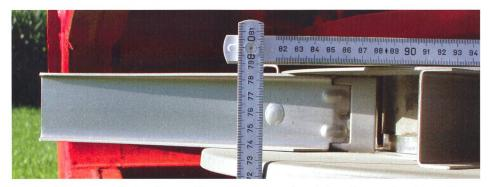
La distance correcte des disques d'épandage de la surface de la culture ou du sol se révèle déterminante pour la qualité du travail d'un épandeur d'engrais.
