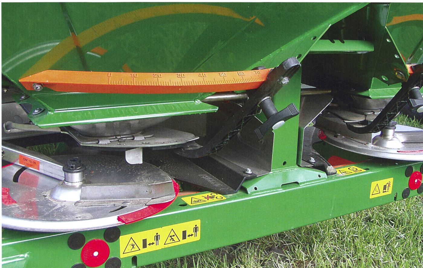
Un réglage précis de l'épandage évite le phénomène dit de « la maladie des bandes techniques ». (Photos: Ruedi Hunger)
