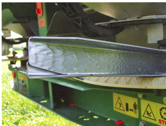
Selon le type d'engrais utilisé, des marques d'usure notable des pales de projection apparaissent.
