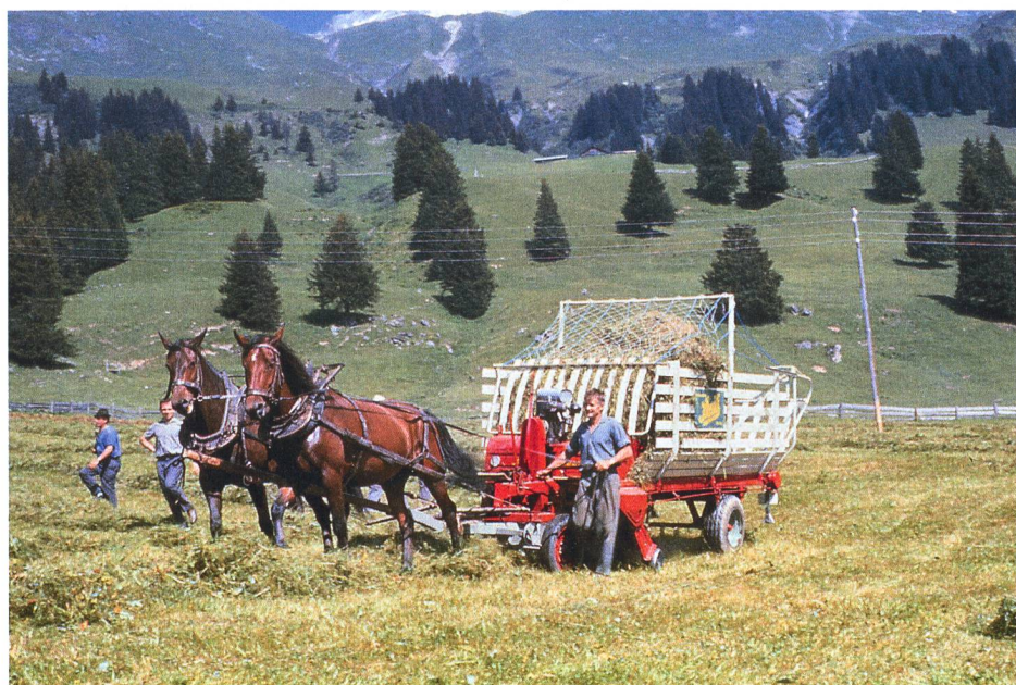
Attelage pour autochargeuse avec moteur auxiliaire.
