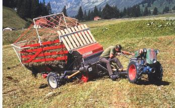
Autochargeuse Rapid Special attelée à un Rapid (10 ch).
