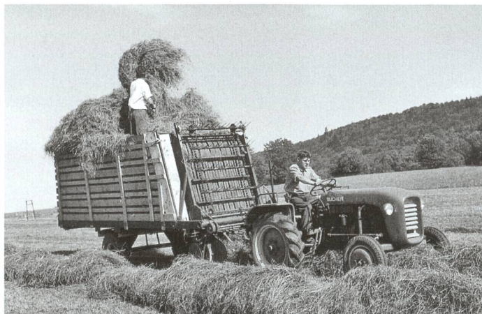
Prototype de convoyeur à chaînes de Bucher (1957).
