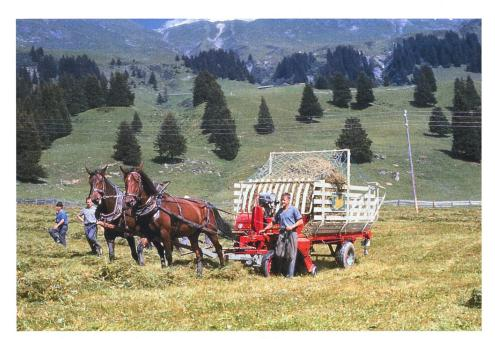
Attelage pour autochargeuse avec moteur auxiliaire.
