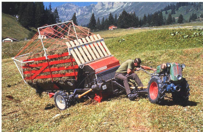
Autochargeuse Rapid Special attelée à un Rapid (10 ch).
