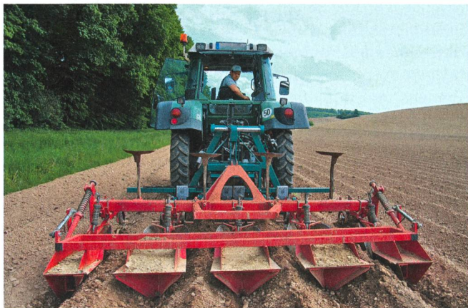
Fig. 6: En haut: Guidage arrière Trimble TrueTracker. Deux antennes permettent de maintenir le tracteur et l'outil attelé simultanément sur la voie. En bas: Le cadre de réglage hydraulique PSR Slide corrige les écarts de l'outil attelé. Source: Geo-Konzept, Reichardt
