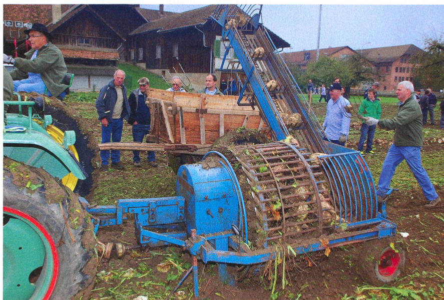
Une récolteuse à tapis roulant transborde les betteraves dans un char à pont.
