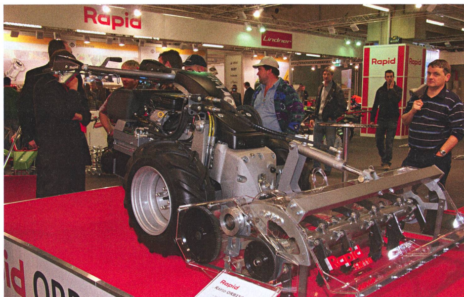
Rapid Orbito avec réglage de l'essieu permettant une répartition optimale du poids. (Photos: Ruedi Burkhalter)
