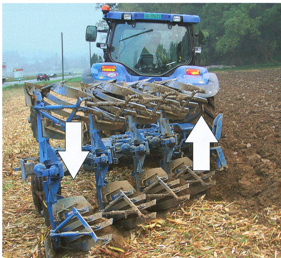
Le point d'attaque de la force verticale de la charrue se déplace, avec l'augmentation de la largeur de travail, de la roue « sillon » vers la roue « terrain ». (Photo : Ueli Zweifel)
