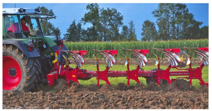
Les connaissances relatives au tassement du sol au niveau de l'horizon de labour doivent être jugées de manière différenciée. Cela ne conduit pas nécessairement à un transfert de poids sur la roue «sillon». (Photo: Ruedi Hunger)
