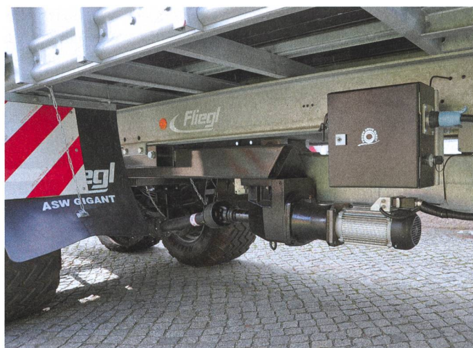
Flygl Agrartechnik a présenté l'essieu électrique « Power DriveElect » pour remorques.
