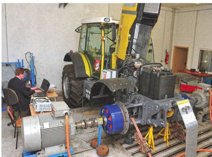
Le RigiTrac EWD 120 diesel électrique a obtenu une médaille d'argent à l'Agritechnica 2011. Quatre moteurs entraînent les moyeux de ses roues. Des tests sont actuellement en cours à l'Université technique de Dresde afin d'améliorer la commande de l'entraînement.
