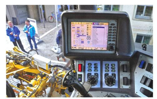
Tableau de contrôle des générateurs et de l'entraînement électrique dans la cabine de l'Euro Tiger V8.
