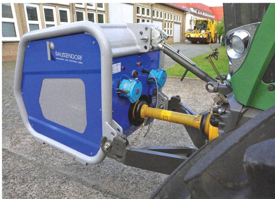
Les sets de générateurs optionnels avec électronique intégrée – ici le PowerPack 45 de Raussendorf – constituent une alternative intéressante pour disposer de l'énergie nécessaire à un entraînement électrique.
