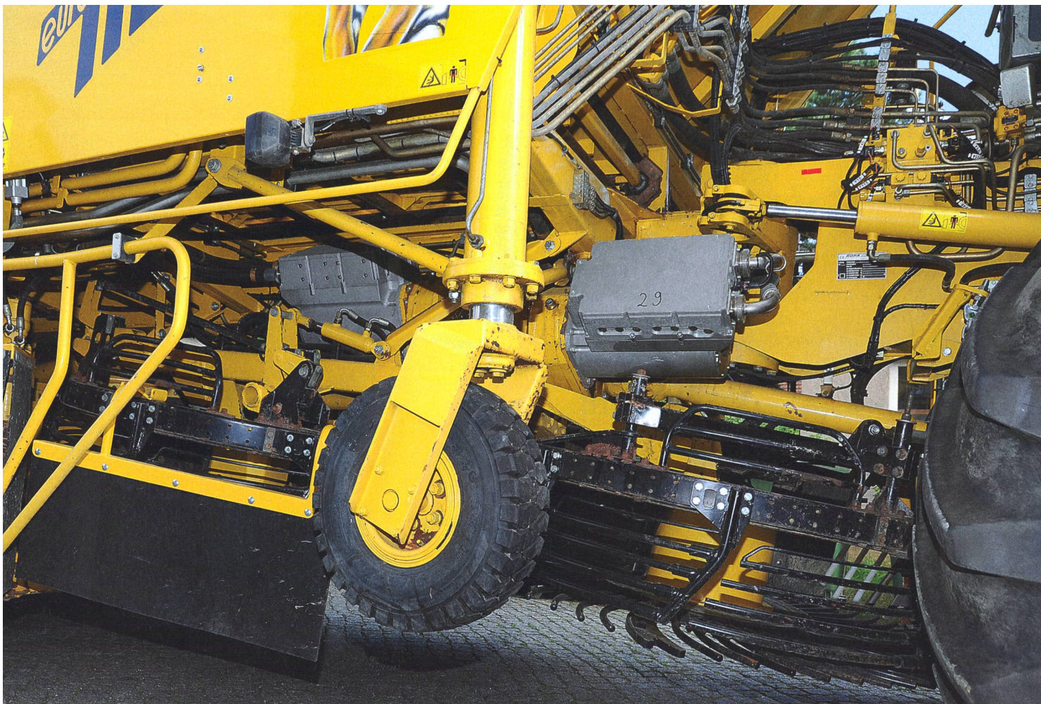
Les deux éléments gris de l'Euro Tiger V8 sont les moteurs électriques hermétiquement fermés de 150 kW servant à l'entraînement de la machine. (Photos: Carmen Rudolph)
