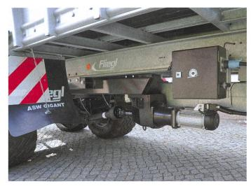
Fliegl Agrartechnik a présenté l'essieu électrique « Power Drive Elect » pour remorques.
