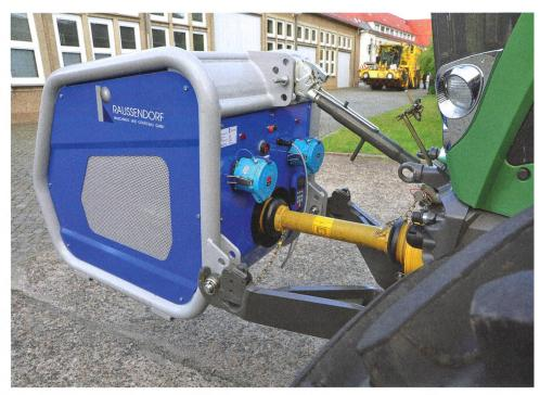
Les sets de générateurs optionnels avec électronique intégrée – ici le PowerPack 45 de Raussendorf – constituent une alternative intéressante pour disposer de l'énergie nécessaire à un entraînement électrique.
