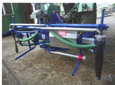
Le modèle en série actuel de l'épandeur comporte des bras rabattables.
