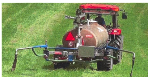
Avant d'entreprendre un transport sur route, le mécanisme hydraulique du modèle « citerne » replie les bras pivotants vers le haut.
