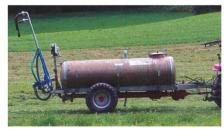
Avant d'entreprendre un transport sur route, le mécanisme hydraulique du modèle «citerne» replie les bras pivotants vers le haut.
