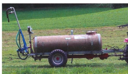
Avant d'entreprendre un transport sur route, le mécanisme hydraulique du modèle « citerne » replie les bras pivotants vers le haut.
