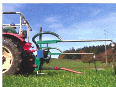
Walter Mai a construit plusieurs prototypes de pendillards. Dans la première version (tout à gauche), le bras basculant était encore monté sur une tête de distribution sphérique. Des améliorations ont été apportées par la suite à la conduite des tuyaux.
