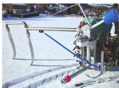
Walter Mai a construit plusieurs prototypes de pendillards. Dans la première version (tout à gauche), le bras basculant était encore monté sur une tête de distribution sphérique. Des améliorations ont été apportées par la suite à la conduite des tuyaux.
