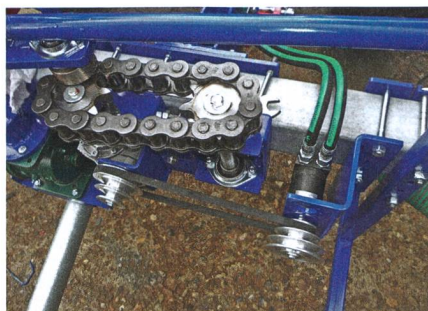
Le mouvement des bras pivotants passant par des tiges métalliques est déclenché par un des maillons de la chaîne.
