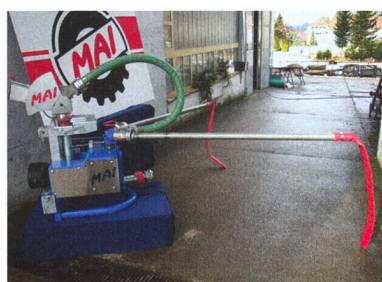
Walter Mai a construit plusieurs prototypes de pendillards. Dans la première version (tout à gauche), le bras basculant était encore monté sur une tête de distribution sphérique. Des améliorations ont été apportées par la suite à la conduite des tuyaux.
