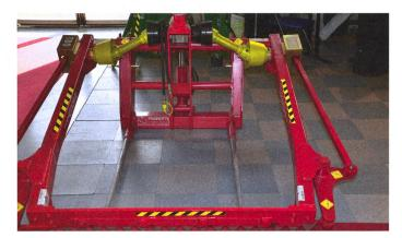
Variante mécanique: la balle ronde est divisée par des couteaux actionnés en sens contraire; la distribution reste un travail manuel.
