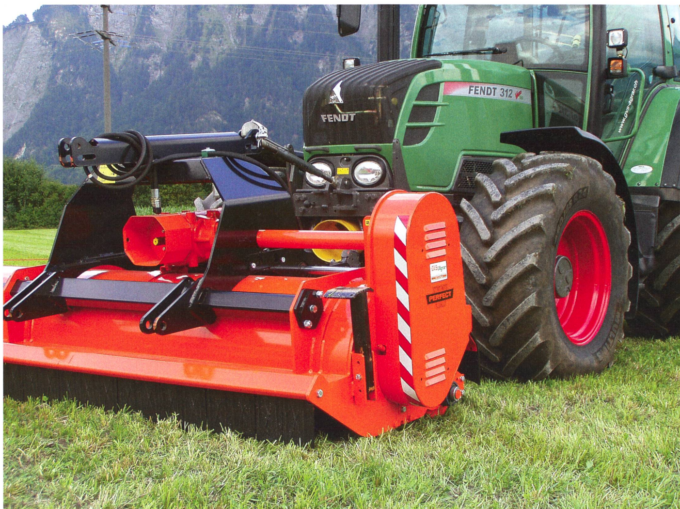
Une quantité moindre de matériau est tassée avec le montage frontal, d'où un meilleur effet de broyage. (Photos: Ruedi Hunger)
