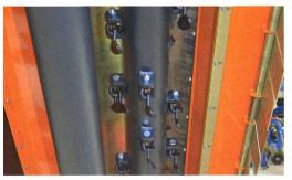
Des fléaux légers en forme de marteau, fixés librement sur un axe de rotation rapide, sont plus efficaces grâce à leur vitesse que grâce à leur poids.
