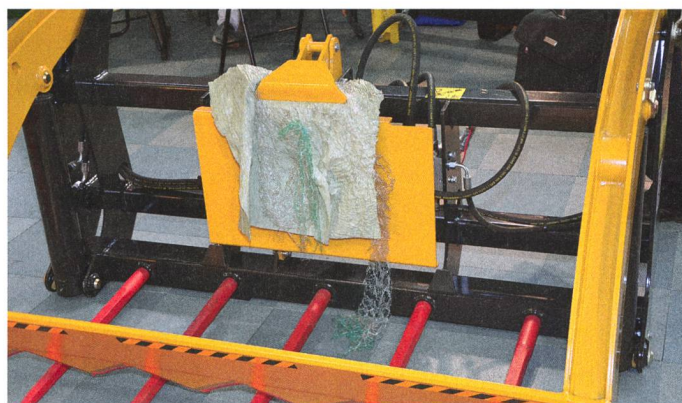
Petit détail pour un grand effet: lorsque la balle ronde est coupée, un système de pinces retient les films et filets de protection qui peuvent ensuite être enlevés sans peine.
