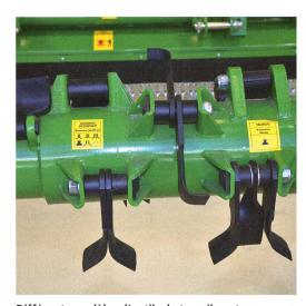
Différents modèles d'outils de travail sont proposés. Hormis les fléaux en forme de marteau bien connus, il existe des fléaux en Y avec une bague de nettoyage et des couteaux anglés.
