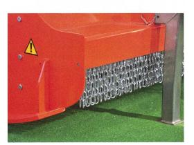
Les éléments de sécurité méritent la plus grande attention car des pierres ou des éléments métalliques peuvent être projetés.
