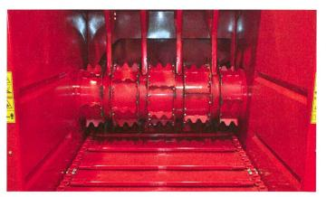
Les outils d'ouverture et de distribution se prêtent aussi à la mise en place d'une litière. Ceux-ci sont en plus munis de lames tranchantes pour renforcer l'effet des rouleaux démêleurs.
