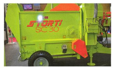
Cet appareil charge à l'arrière les balles rondes pour les ouvrir et ensuite distribuer le fourrage sur la table d'affourragement. Il est aussi en mesure d'installer une litière avec une turbine en plus.
