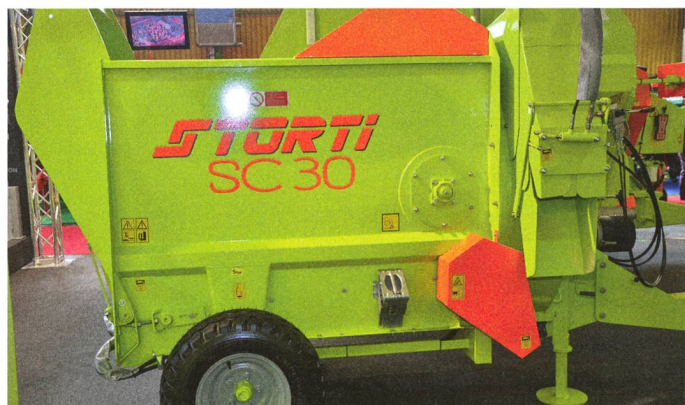
Cet appareil charge à l'arrière les balles rondes pour les ouvrir et ensuite distribuer le fourrage sur la table d'affouragement. Il est aussi en mesure d'installer une litière avec une turbine en plus.
