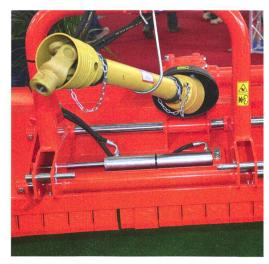
Un dépôt de côté est livré sur demande. C'est particulièrement utile pour éviter de rouler sur les chaumes de maïs.
