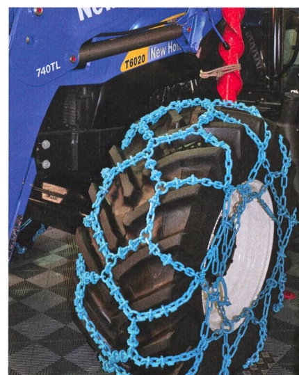
Cette chaîne est composée d'anneaux rectangulaires en acier, tous surmontés d'une pièce d'usure, en acier de haute qualité. Outre une mordance optimale dans la glace et la neige, elle assure un bon silence de roulement.
