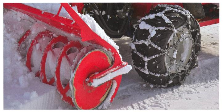
Les chaînes à neige permettent de bien circuler sur une chaussée enneigée en assurant l'efficacité du freinage et du guidage latéral. (Photo: Ruedi Hunger)
