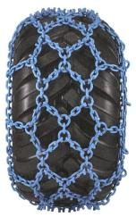
Chaîne à neige conçue pour le travail en forêt dans des conditions particulièrement difficiles. On relèvera la disposition asymétrique des éléments saillants pour l'agrippement. (Photo: PEWAG)
