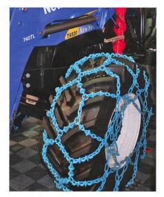
Cette chaîne est composée d'anneaux rectangulaires en acier, tous surmontés d'une pièce d'usure, en acier de haute qualité. Outre une mordance optimale dans la glace et la neige, elle assure un bon silence de roulement.
