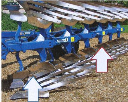
**Equipement additionnel:** Les déflecteurs à paille sont positionnés régulièrement et pas trop à la verticale. Ainsi, le matériel peut s'écouler rapidement sans se trouver enterré trop profondément. Les extensions des rasettes doivent aussi être contrôlées et, si nécessaire, remises toutes en position identique.
