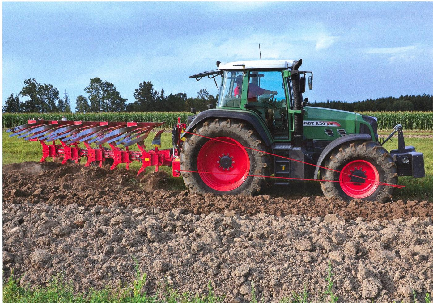
Positionnement des bras inférieur et supérieur: Les «lignes de fuite» des bras inférieur et supérieur doivent se croiser au niveau de l'essieu avant (entre juste devant et juste derrière, selon la pratique et la littérature), ce qui garantit une bonne répartition avant/arrière de l'effort de traction.
