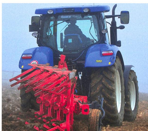
**Position de la roue d'appui:** Certaines charrues offrent diverses options de montage de la roue d'appui oscillante. Une des positions permet de modifier le déport pour le labourage en bordure de champ. La position de la roue d'appui affecte aussi celle du bras supérieur du trois-points qui, selon la situation, ne peut plus être fixé au trou de fixation oblong.
