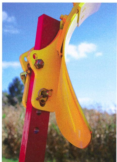
**Réglage des rasettes:** Le positionnement correct des rasettes influe sur la qualité du travail de la charrue. Alors que le réglage avec vis se fait avec un double mètre et une clé plate pour les modèles anciens, les constructeurs de charrues proposent aujourd'hui des systèmes de réglage rapide.
