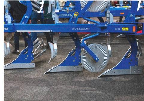
**Coutre à disque:** Le coutre à disque ne doit pas empiéter sur la rasette, le cas échéant. Une emprise latérale de 1 à 2 centimètres s'avère optimale. Le coutre à disque doit pouvoir osciller à gauche et à droite. Habituellement, un coutre à disque travaille sur un tiers à la moitié de la profondeur de labour.
