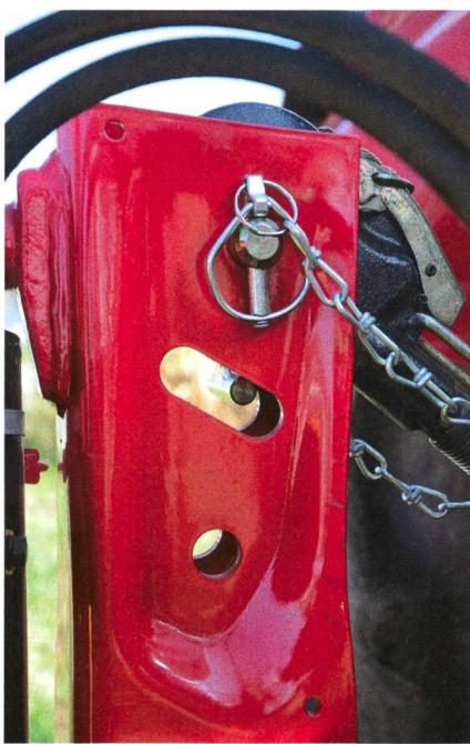
**Fixation du bras supérieur:** De nombreuses charrues ont un trou de fixation oblong supplémentaire pour le bras supérieur du trois-points. Cet orifice peut être utilisé avec les charrues de 4 socs et plus. La position de la roue d'appui a une incidence sur l'utilisation de ce trou de fixation. Mais son emploi n'a pas de sens quand le tracteur possède un bras supérieur réglable, car la fonction de contrôle d'effort du relevage risque d'en être altérée.
