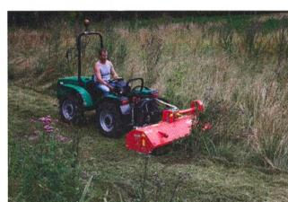
Idéalement positionné entre le TL et le BKE dans la gamme broyeur herbe, le BE série 10 a été spécialement conçu pour le broyage des espaces enherbés tels que parcs et jardins, à l'aide de microtracteurs (35-55 Ch). Les largeurs de travail disponibles sont de 1,40 m, 1,60 m, 1,80 m et 2,00 m.
