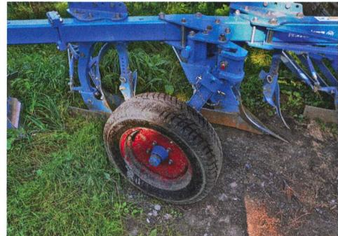
**Position du bâti (talonnage):** La charrue doit être ajustée de telle sorte que son bâti soit parallèle à la surface du sol. Le réglage du bras supérieur du trois-points permet d'assurer une profondeur de travail uniforme du premier au dernier soc.
