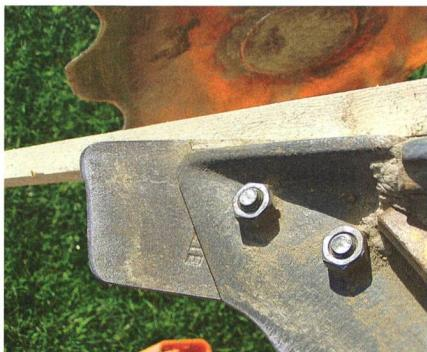
**Attaque latérale:** Une légère attaque latérale dans le sol non labouré assure un bon guidage de la charrue et veille à un travail de qualité. Un excès d'attaque verticale et latérale augmente la force de traction nécessaire et donc la consommation de carburant.
