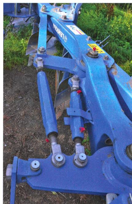
**Réglage de la largeur de coupe:** Le «centre de réglage» permet de régler à la fois la largeur de coupe du premier soc, ainsi que de définir le point de traction. La largeur de coupe du premier soc doit être égale à celle des autres socs. L'aplomb et la largeur de travail du premier soc sont étroitement liés.
