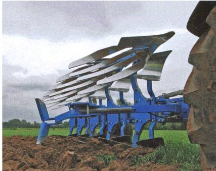
**Profondeur des rasettes:** La rasette, comme son nom l'indique, doit « peler » le sol sur quelques centimètres. Si des bourrages surviennent, les rasettes doivent être éventuellement positionnées un peu plus profondément.
