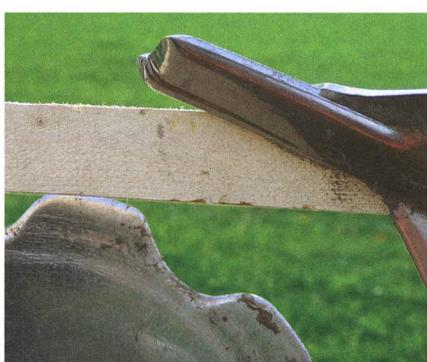
**Attaque verticale:** La pointe du soc doit se trouver de 2 à 4 centimètres au-dessous du niveau du corps. Cela assure une pénétration rapide et une profondeur de travail uniforme. L'usure diminue l'efficacité de la pointe du soc.
