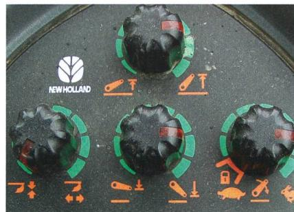
**Sélection contrôle de position/d'effort:** Pour le labour proprement dit, sélectionner l'option contrôle d'effort du tracteur (voir manuel d'utilisation); de la sorte, le poids de la charrue appuie sur l'essieu arrière. Pour les trajets sur route, mieux vaut, pour des raisons de sécurité, utiliser la position contrôle de position.
