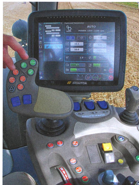
L'accoudoir regroupe pratiquement toutes les fonctions du tracteur. Il intègre même un levier en croix pour la commande de deux distributeurs hydrauliques; la forme du levier d'avancement a fait l'objet d'une recherche ergonomique avec des agriculteurs. Le pouce joue un grand rôle pour les différentes commandes.
