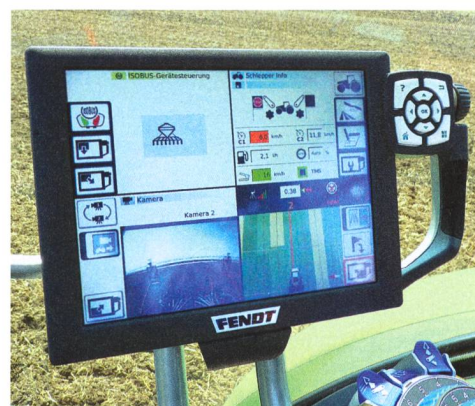
Le grand terminal Vario se retrouve en standard sur les modèles ProfiPlus (option sur les variantes Profi). Son écran tactile de 10,4 pouces se divise en quatre et permet d'afficher les images provenant de deux caméras.
