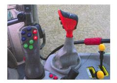
La grille du levier des gammes se présente désormais dans l'axe du bras du conducteur, de façon à faciliter les changements de rapports. Auparavant, elle se trouvait dans l'axe du tracteur.
