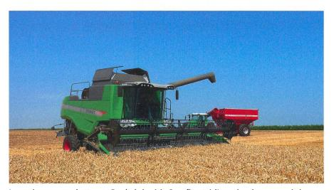
Les moissonneuses-batteuses Fendt de la série C profitent, à l'occasion du passage de leur motorisation à la norme antipollution Stage IIIB, d'un nouveau design. La 5275 C et la 6335 C sont proposées avec un châssis classique ou Paralevel (PL) conçu pour récolter en dévers dans les pentes jusqu'à 20 %.
