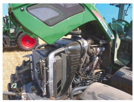
Les 500 Vario adoptent des moteurs Deutz à technologie antipollution par réduction catalytique sélective (SCR) avec adjonction d'AdBlue pour satisfaire à la norme Stage IIIB.
