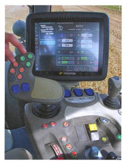
L'accoudoir regroupe pratiquement toutes les fonctions du tracteur. Il intègre même un levier en croix pour la commande de deux distributeurs hydrauliques; la forme du levier d'avancement a fait l'objet d'une recherche ergonomique avec des agriculteurs. Le pouce joue un grand rôle pour les différentes commandes.
