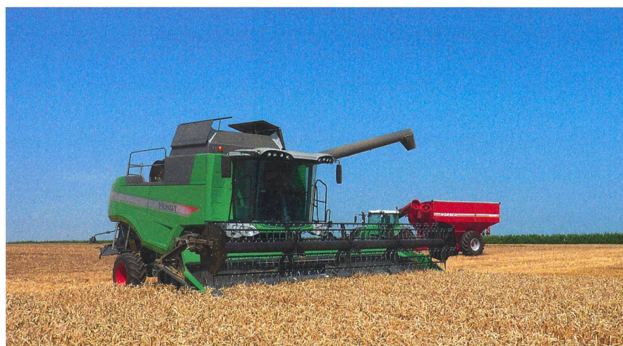
Les moissonneuses-batteuses Fendt de la série C profitent, à l'occasion du passage de leur motorisation à la norme antipollution Stage IIIB, d'un nouveau design. La 5275 C et la 6335 C sont proposées avec un châssis classique ou Paralevel (PL) conçu pour récolter en dévers dans les pentes jusqu'à 20 %.
