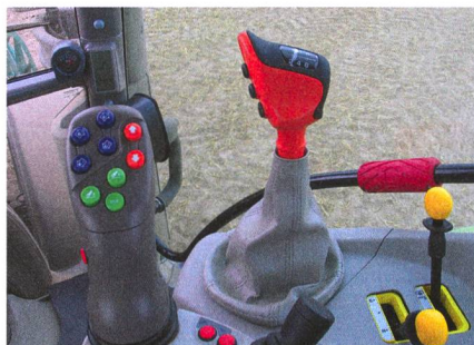
La grille du levier des gammes se présente désormais dans l'axe du bras du conducteur, de façon à faciliter les changements de rapports. Auparavant, elle se trouvait dans l'axe du tracteur.
