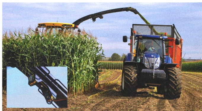
Le système IntelliFill permet un remplissage précis de la remorque, même avec de mauvaises conditions de visibilité, grâce à une caméra 3D.
