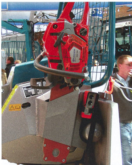
Certains treuils peuvent, en option, être équipés d'éléments pour fixer tronçonneuse et autres outils qui sont ainsi faciles à retrouver !
