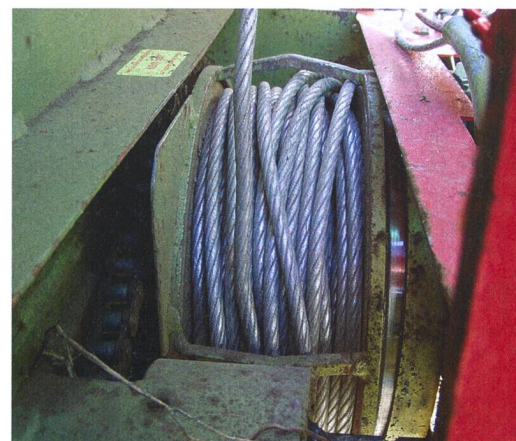
Enroulement désordonné = dégâts au câble programmés.
