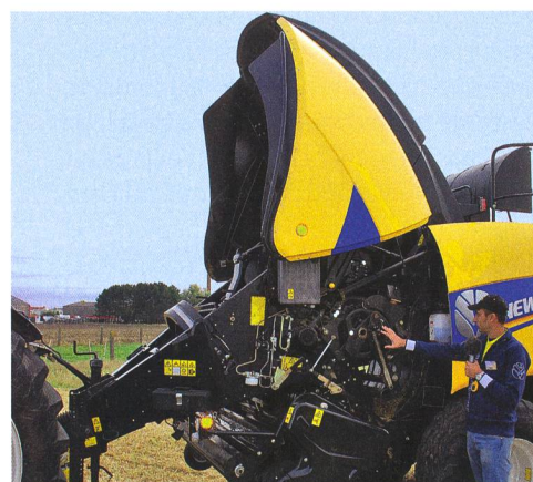
Le capot frontal ouvert permet d'atteindre les principaux points d'entretien.
