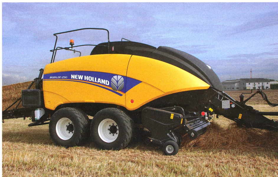
Le design élégant est trompeur : les panneaux latéraux sont d'un seul tenant et la zone de maintenance sur le dessus de la machine est plate. (Photo : Dominik Senn)
