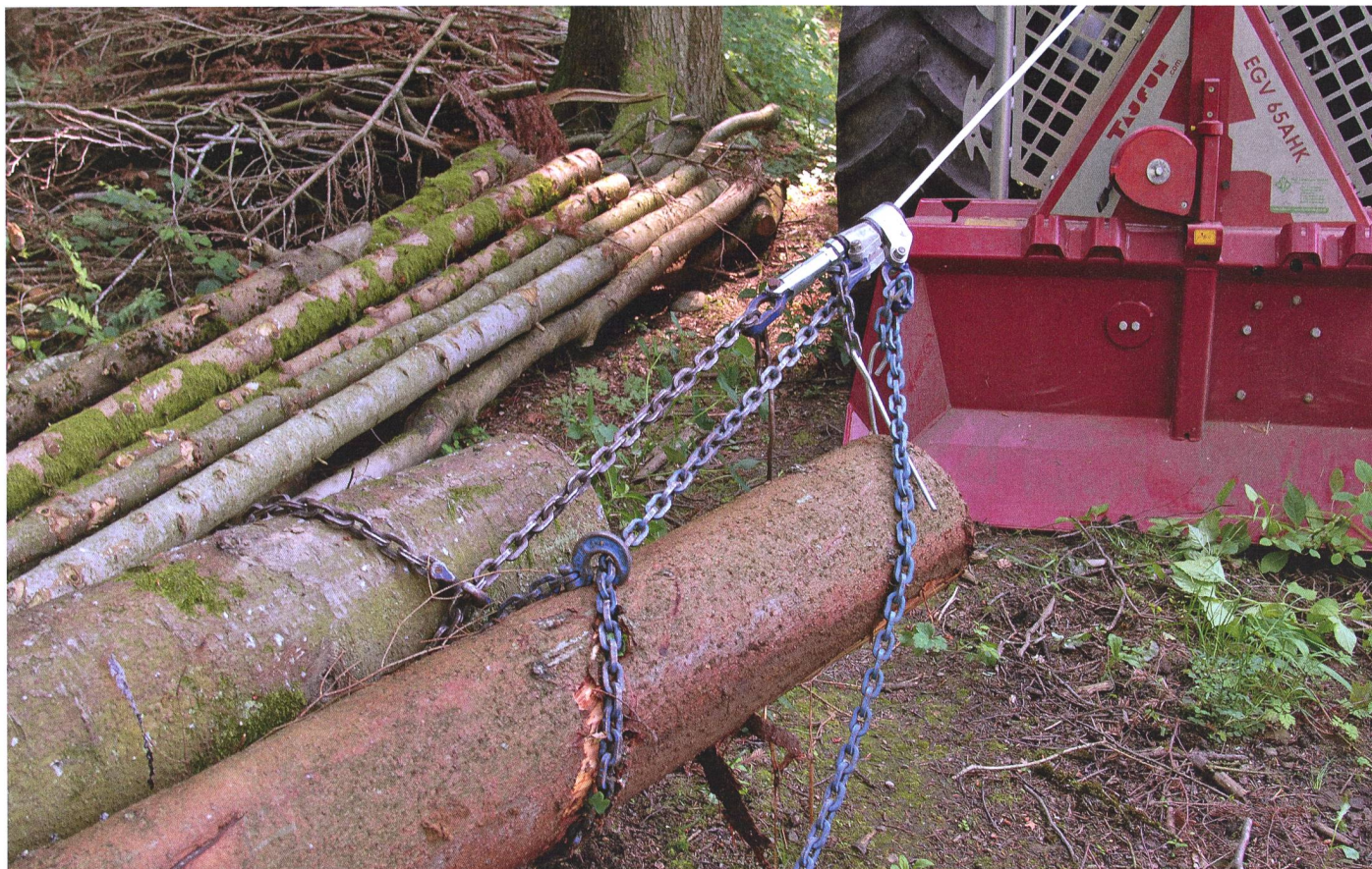
Les câbles synthétiques nécessitent un épissage terminal adapté. (Photos: Ruedi Burgherr)
