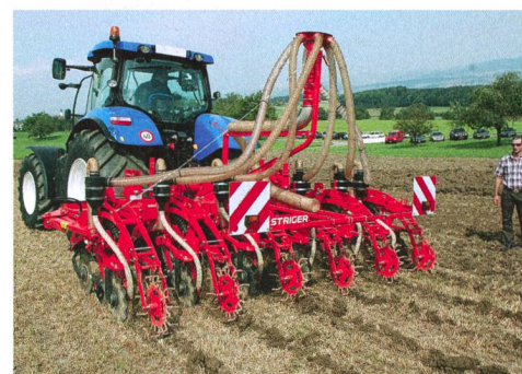
Le striger permet un travail du sol par bandes ainsi que d'avancer à une vitesse d'au moins 10 km/h.
