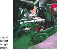
Dans ce cas, le compresseur est intégré au triangle de fixation.
