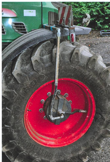
Les fixations des supports rotatifs sont réalisées avec du fer plat.
