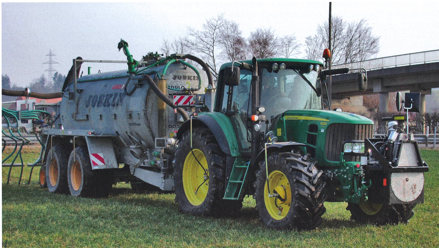
Grâce à une pression réduite, le poids du véhicule se répartit sur une plus grande surface. (Photos : Ruedi Burkhalter)
