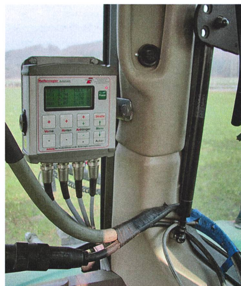
Les pressions des pneus peuvent être présélectionnées sur l'ordinateur de bord.
