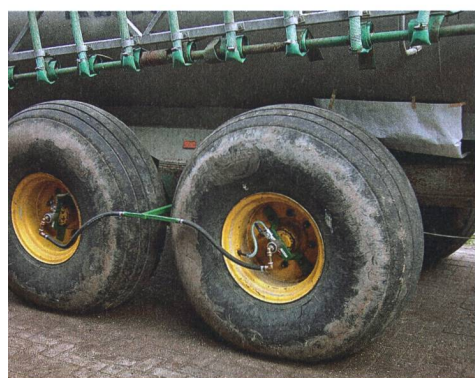
Une seule conduite suffit pour les deux essieux de la remorque.
