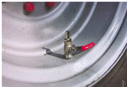
Pour le montage, un trou est percé dans la jante et une soupape à bille installée ensuite.
