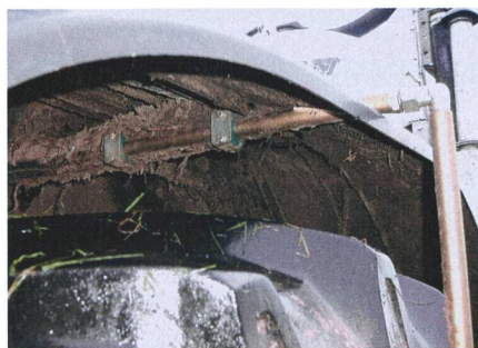
Les conduites d'air passent par le garde-boue.
