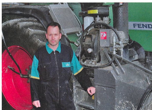
Adrian Arni a monté le compresseur supplémentaire à droite de la cabine.
