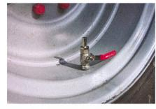
Pour le montage, un trou est percé dans la jante et une soupape à bille installée ensuite.
