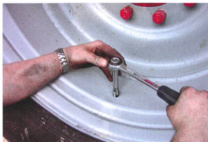
Pour le montage, un trou est percé dans la jante et une soupape à bille installée ensuite.
