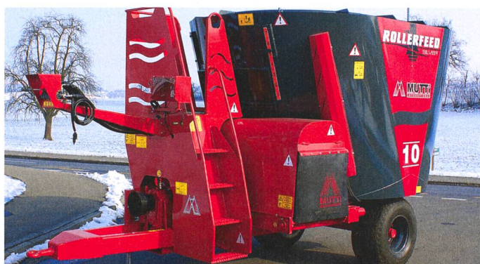
Mélangeuse verticale de 10 m 3 adaptée pour les exploitations de 40 à 50 vaches (observer le volume du conteneur). (Photo: Martin Rickli)
