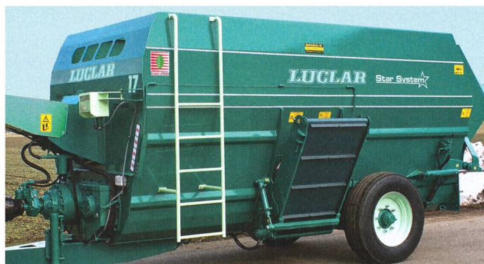
Remorque mélangeuse tractée de 17 m 3 avec vis de mélange horizontale et conteneur de chargement pour le remplissage par l'arrière.
