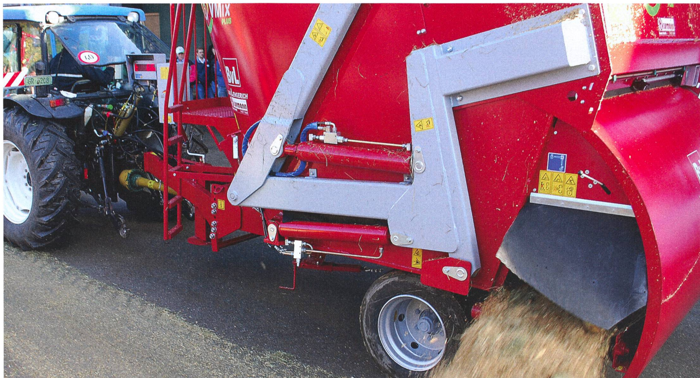
Tous les constructeurs proposent maintenant des équipements individuels avec leurs mélangeuses; parmi elles la mélangeuse verticale avec dispositif de remplissage. (Photo: Astrid Böll)
