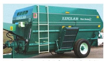
Remorque mélangeuse tractées de 17 m³ avec vis de mélange horizontale et conteneur de chargement pour le remplissage par l'arrière. (Photo: Martin Rickli)
