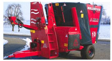
Mélangeuse verticale de 10 m³ adaptée pour les exploitations de 40 à 50 vaches (observer le volume du conteneur). (Photo: Martin Rickli)
