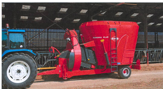
Une remorque mélangeuse doit de plus en plus disposer d'équipements en plus (ici une soufflerie complémentaire) permettant par exemple le paillage avec différents matériaux. (Photo d'usine)
