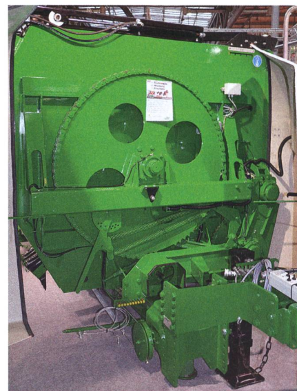
Le grand diamètre du pignon d'entraînement à chaîne de la mélangeuse à pales Keenan permet de limiter l'usure.
