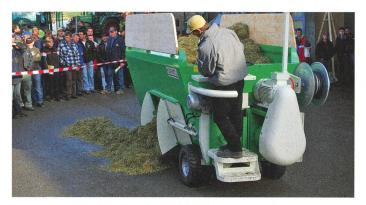
Le constructeur suisse Kuratli-Maschinenbau propose des mélangeuses entraînées par des moteurs électriques silencieux et respectueux de l'environnement.
