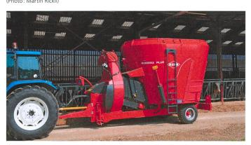
Une remorque mélangeuse doit de plus en plus disposer d'équipements en plus (ici une soufflerie complémentaire) permettant par exemple le paillage avec différents matériaux. (Photo d'usine)
