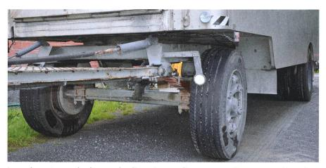
Les essieux et roues de plus grandes dimensions ont l'avantage que l'on n'est pas dérangé par des passages de roues. La plate-forme de chargement est alors plus élevée.
