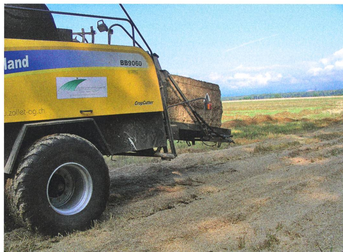
Les presses à balles carrées sont bien adaptées au pressage de la balle.
