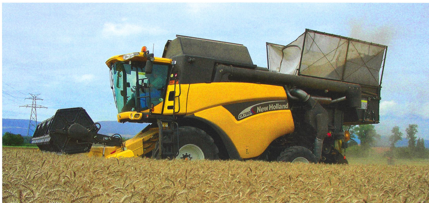
Récolteuse de balle à la HESA (Zollikofen) avec bunker permettant de limiter les pertes.
