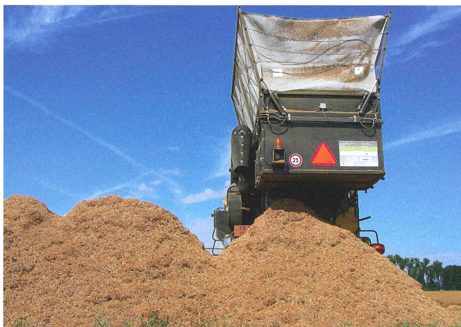
Récolte de pois: grâce au bunker rabattable, la récolteuse de balle HESA a des dimensions très compactes.
