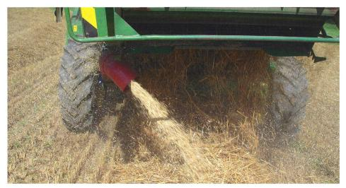
Prototype HESA de mise en andains. (Photo: W. Güller)
