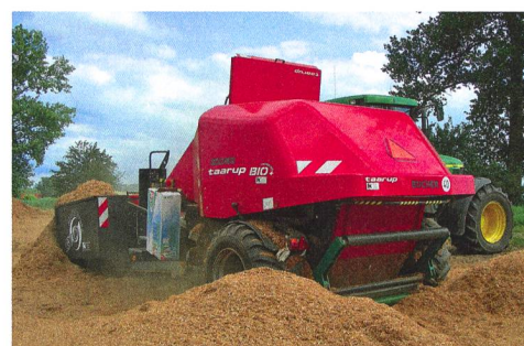
Presse à balles rondes Bale in One de Taarup, avec équipement spécial maïs, utilisée pour le pressage de la balle.
