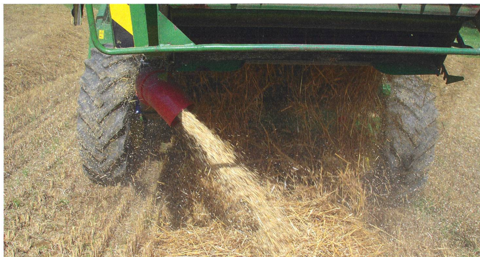
Prototypé HESA de mise en andains. (Photo : W. Güller)
