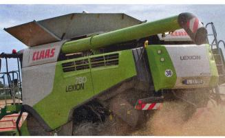
modèle haut de gamme dispose désormais d'une trémie dont la capacité maximale s'élève à 12 500 l, les performances de déchargement étant de 130 l/s.
