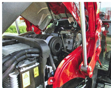
Le filtre à particules diesel du Farmall U est placé derrière le moteur.
