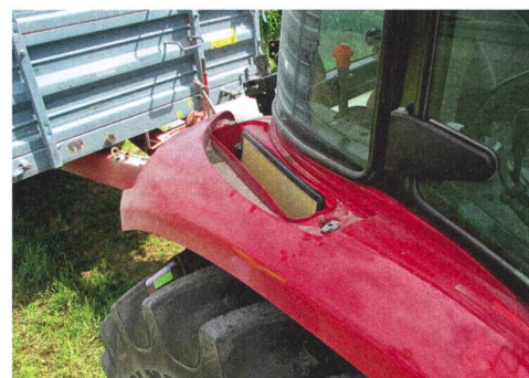
Les filtres à air de la cabine sont très accessibles car placés dans les garde-boue.
