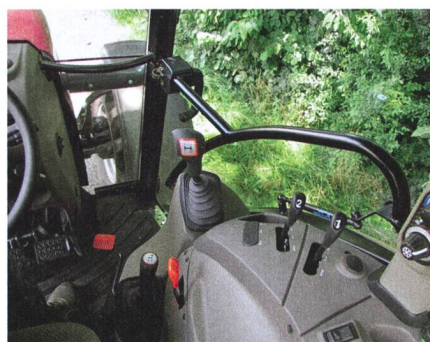
Levier de commande principal et de groupes du Farmall C.
