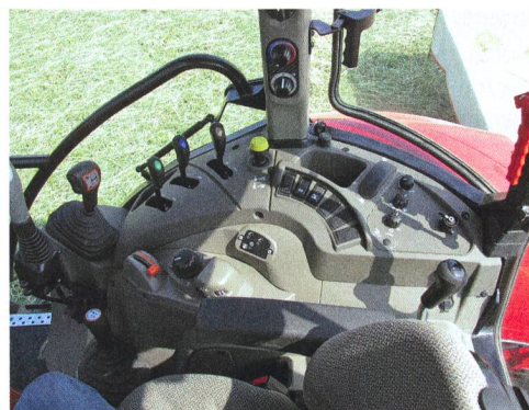
Eléments de commande du Farmall U.
