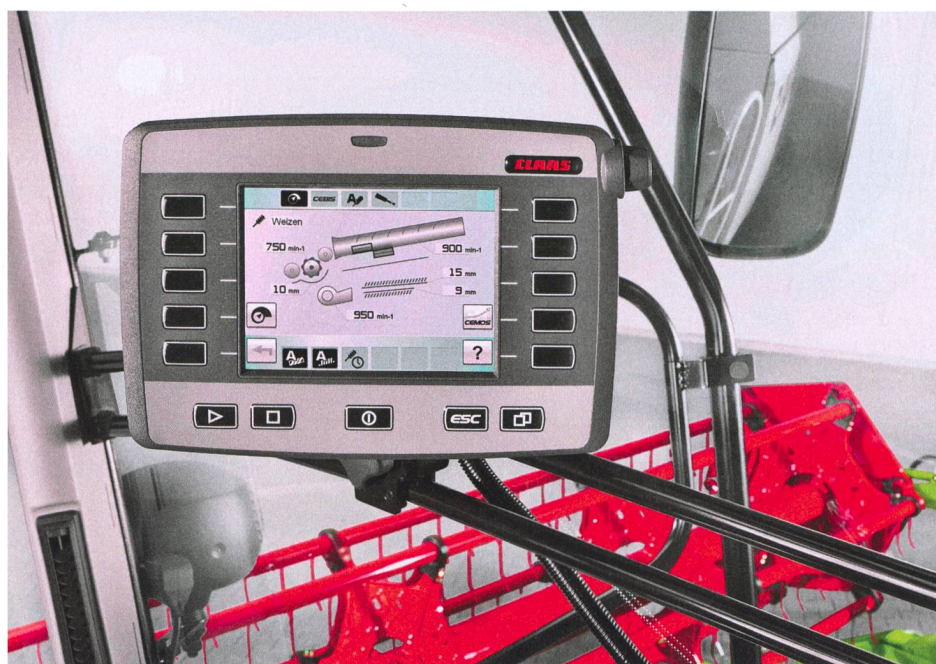
L'écran Cebis Terminal permet en tout temps au conducteur de prendre connaissance des fonctions automatiques qui se déroulent.
