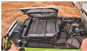
Le module de refroidissement est placé horizontalement derrière le moteur.
