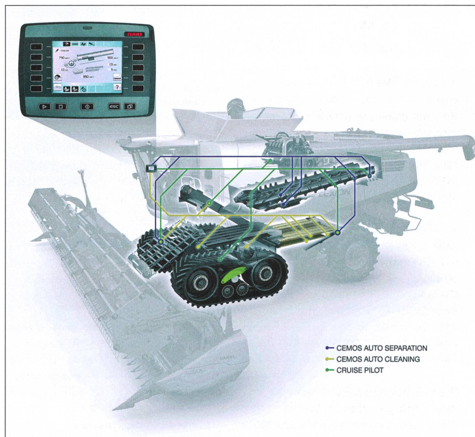
Le système électronique Cemos Automatic met en lien les différents systèmes Cemos Auto Separation, Cemos Auto Cleaning et Cruise Pilot.
