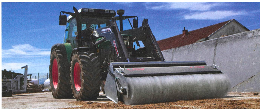
Une combinaison brosse-pelle frontale constitue le moyen de nettoyage idéal pour les places en dur, les chemins et les routes.
