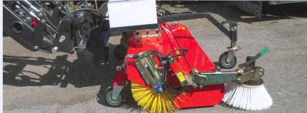
Pour obtenir un bon résultat, il est nécessaire de procéder à un ajustement approprié. Selon le type de surface et de route, les brosses de nettoyage son réglées en hauteur de sorte à adapter leur agressivité.
