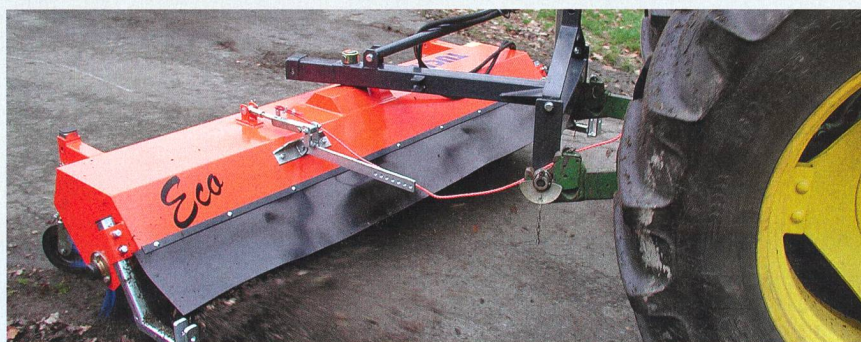
Une machine de nettoyage à l'arrière remplit les conditions pour la remise en état des routes et des chemins, car son montage est rapide.
