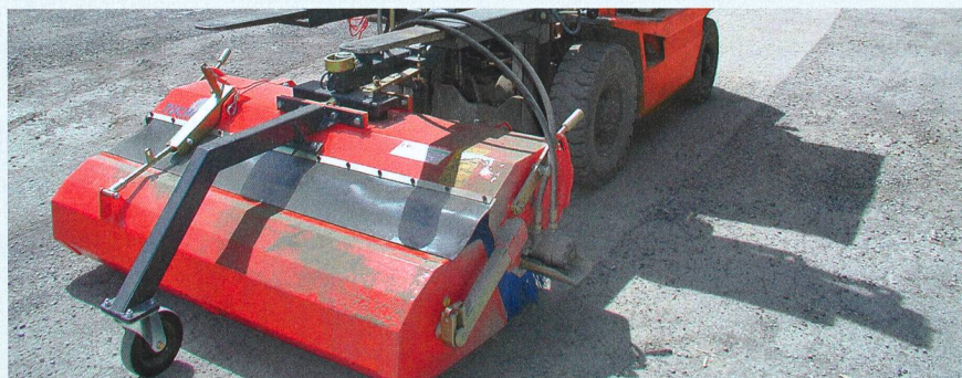
L'entraînement hydraulique latéral dépasse sur le côté de la machine et doit par conséquent être protégé.
