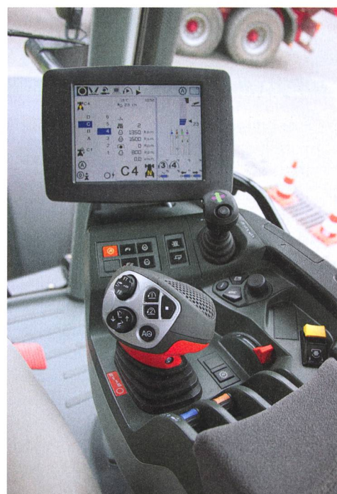
Console de commande Cebis avec levier de conduite multifonction C-Motion.
