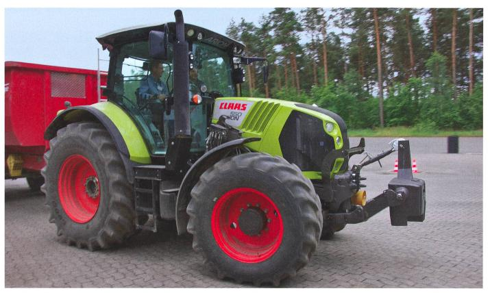
Arion 550 – Le plus puissant quatre cylindre Claas en action comme machine de traction et équipé d'un demi-cadre permettant l'accouplement des consoles du chargeur et de l'hydraulique frontaux. (Photos: Ueli Zweifel)
