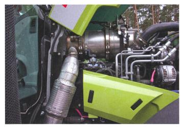
Catalyseur diesel à oxydation (DOC) et filtre à particules (DPF).
