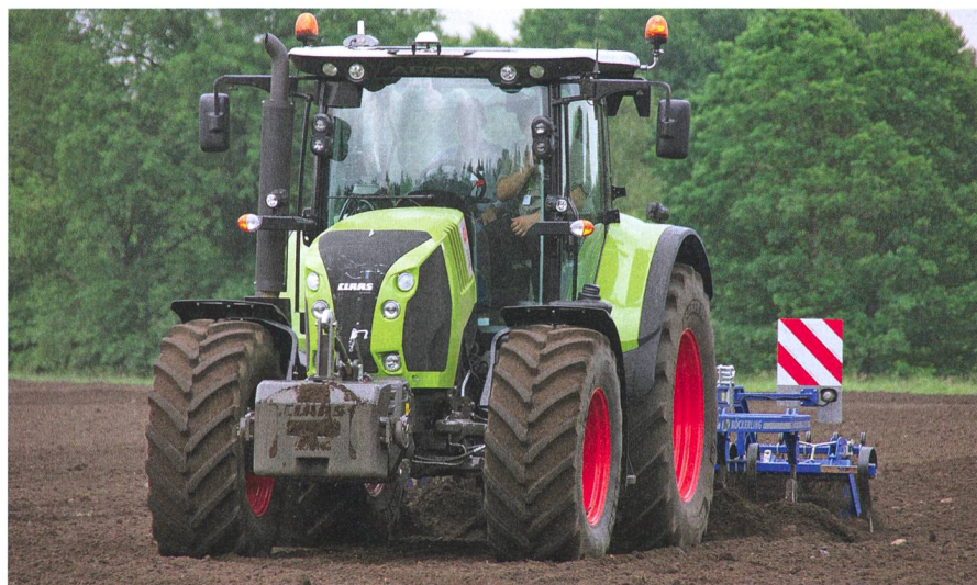
Engagement typique de l'Arion 650 en grandes cultures, ceci avec le système de guidage automatique Claas GPS Pilot.
