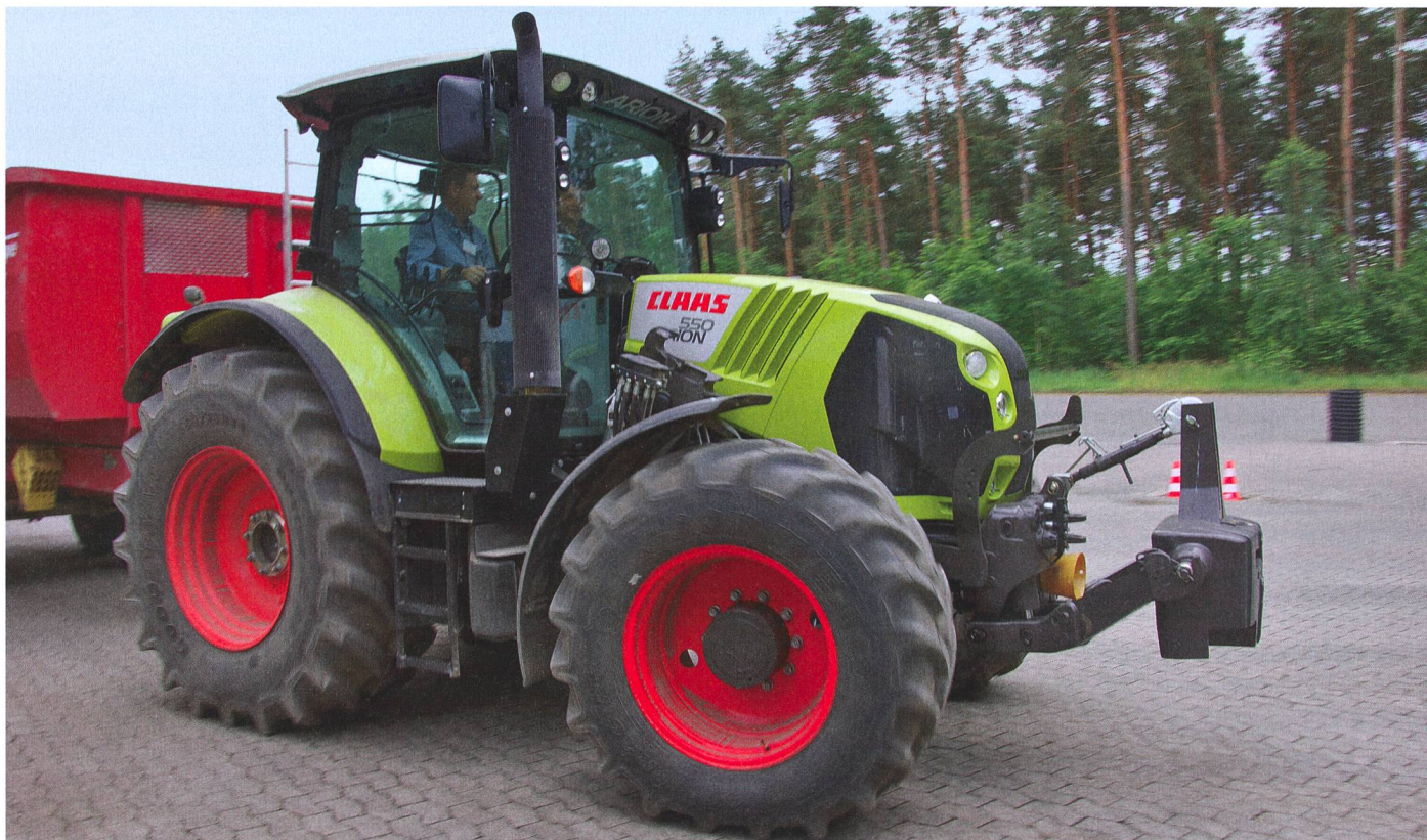
Arion 550 – Le plus puissant quatre cylindre Claas en action comme machine de traction et équipé d'un demi-cadre permettant l'accouplement des consoles du chargeur et de l'hydraulique frontaux. (Photos: Ueli Zweifel)
