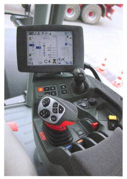
Console de commande Cebis avec levier de conduite multifonction C-Motion.
