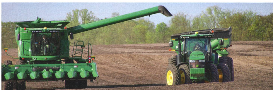
MaschineSync: par le biais de l'électronique, le conducteur de la moissonneuse-batteuse dirige l'attelage tracteur-remorque pour la vidange de la trémie et adapte la position de la remorque afin d'assurer un remplissage uniforme.
