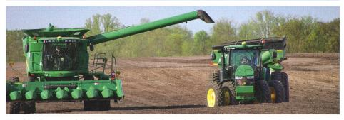
MaschineSynce: par le biais de l'électronique, le conducteur de la moissonneuse-batteuse dirige l'attelage tracteur-remorque pour la vidange de la trémie et adapte la position de la remorque afin d'assurer un remplissage uniforme.
