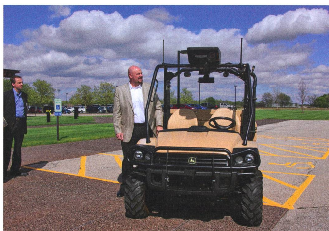
En test au Centre de recherche de Moline : bardé d'électronique, suivi par satellite, guidé par signal de correction et capteur infrarouge, ce véhicule trouve la meilleure façon de se déplacer de A à B automatiquement et avec contrôle à distance. Il est capable de s'arrêter devant les obstacles ou de les éviter.
