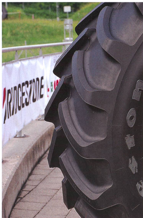
Avec Dual Angle, les barrettes offrent une plus grande surface de contact grâce à leur angle de 35° sur leur partie antérieure.
