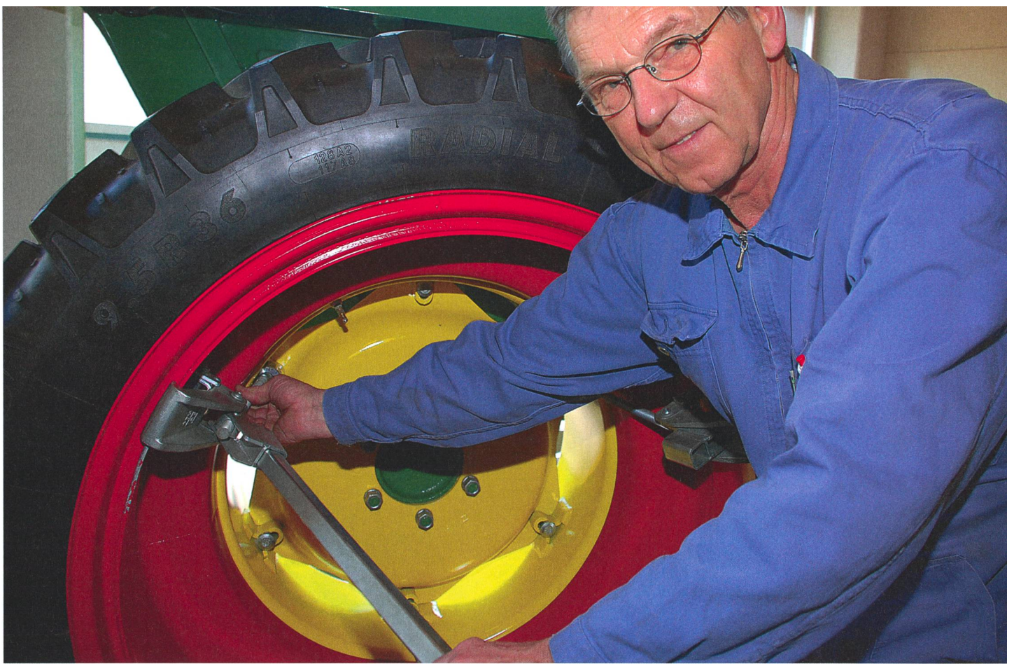
Cofondateur de la fabrique, Rudolf Schaad montre le système breveté à l'échelon international de fermeture rapide. (Photos: Dominik Senn)
