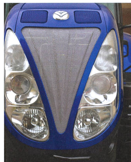
La forme des phares est déterminée par des designers. Grâce à une conception moderne, elles peuvent contenir des lentilles, des prismes et des éléments combinés.
