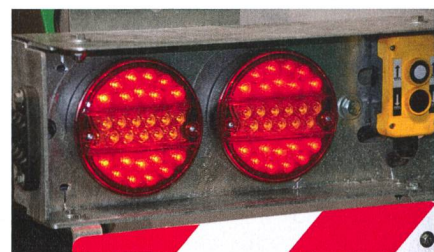
Chère mais adéquate : la technique LED à l'arrière des véhicules ; elle brille davantage et s'avère mieux visible, surtout de jour.
