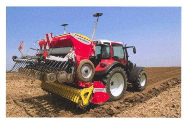
Grâce au relevage anticipé du semoir au dessus de l'outil porté, l'essieu avant est moins déchargé.
