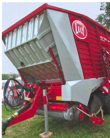
La paroi frontale rabattable de la Tigo permet d'adapter la compression en fonction des particularités du fourrage.
