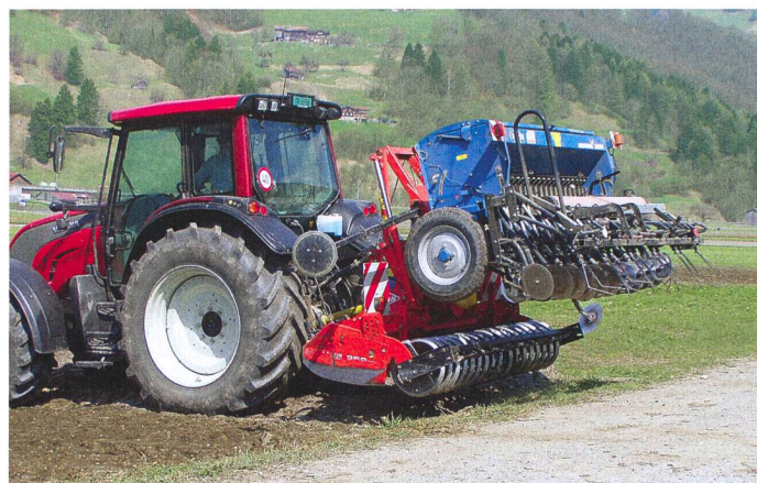
Des combinaisons de semis chargent fortement l'essieu arrière du tracteur. La limite de tolérance sur route est souvent atteinte.
