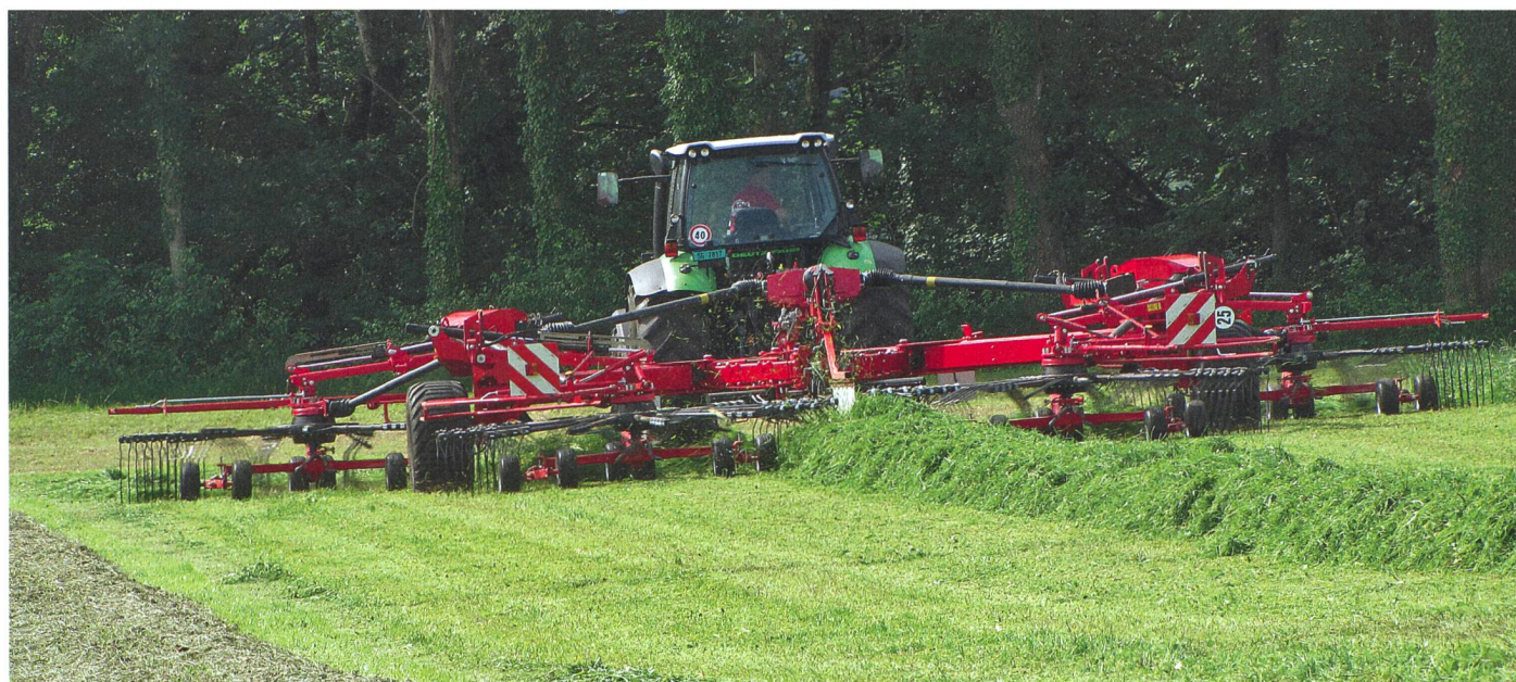
L'Hibiscus 1515 CD Profi est équipé d'un châssis original en forme de V.
