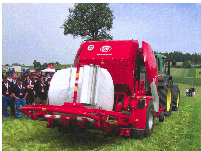
Lors de l'enrubannage, la bague de la Tornado se place en position horizontale. Elle remonte pour le dépôt de la balle.
