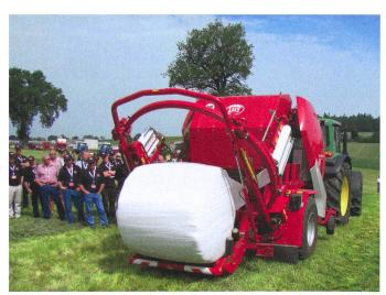
Lors de l'enrubannage, la bague de la Tornado se place en position horizontale. Elle remonte pour le dépôt de la balle.
