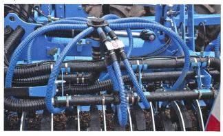
nière très dense, ainsi que **Pour limiter la longueur des tuyaux des semoirs pneuma**des individus isolés. Néantiques d'une largeur supérieure à trois mètres, plusieurs moins toutes les graines ont distributeurs de grains sont implantés.
