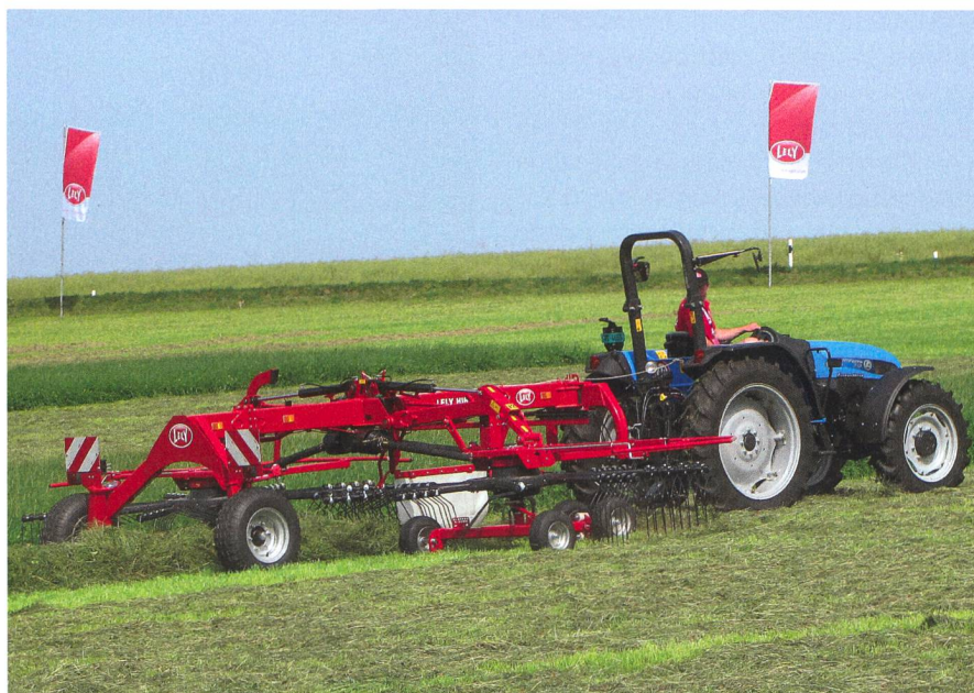
La ligne CD-Linie complète les andaineurs à deux rotor.
