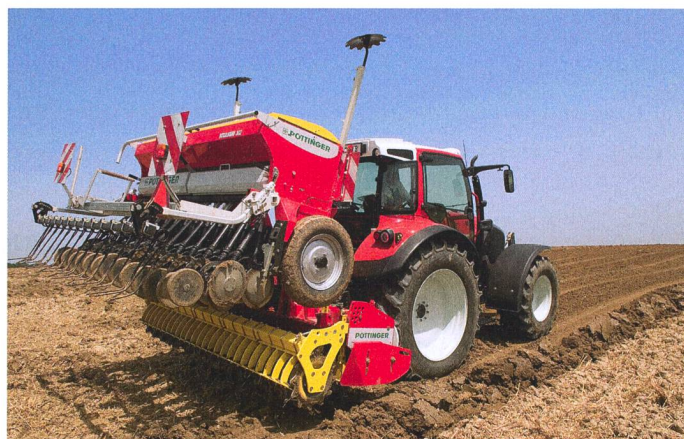
Grâce au relevage anticipé du semoir au dessus de l'outil porté, l'essieu avant est moins déchargé.
