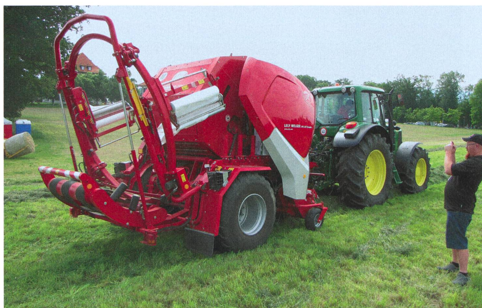
La combinaison presse-enrubanneuse Tornado est maintenant disponible avec une presse à chambre fixe. Lors du processus de pressage, la bague d'enrubannage est rabattue vers le haut.
