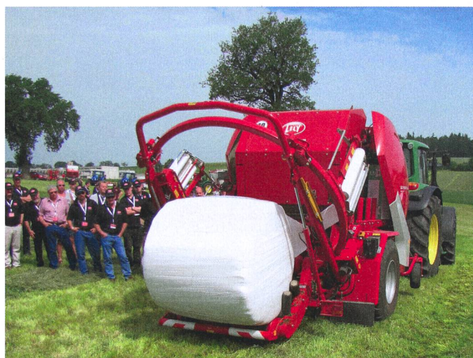
Lors de l'enrubannage, la bague de la Tornado se place en position horizontale. Elle remonte pour le dépôt de la balle.
