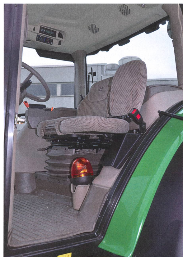
Le test DLG a évalué l'accélération verticale du conducteur, l'effort requis pour le réglage du siège ainsi que le confort de conduite.
