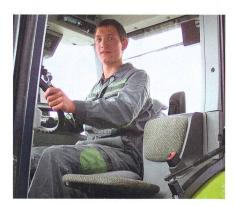
En raison de l'ajustement du poids – entièrement automatique – un siège moderne haut confort prend toujours la position idéale pour le conducteur. Atteindre les butées supérieure ou inférieure s'avère pratiquement exclu.
