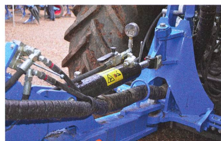
Avec un renforceur de traction, un transfert du poids se fait sur l'essieu arrière, ce qui limite le patinage et la consommation de carburant.
