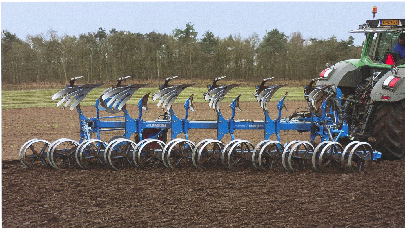
Ajustement automatisé de Pack Flex à la largeur de travail de la charrue Vario. (Photo: Lemken)
