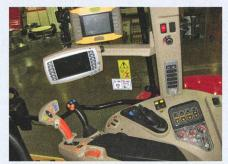
Sur la finition haut de gamme Exclusive, un accoudoir associe le levier d'avancement Multipad et le joystick de commande électrique des distributeurs.
