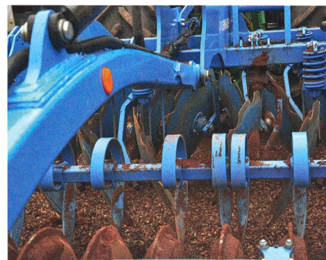
Les disques sont disposés de manière à éviter les problèmes avec la zone médiane.
