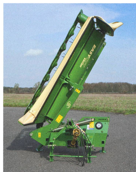
Grâce à leur bonne répartition du poids, les faucheuses arrière se placent en position transport en prenant très peu de place.
