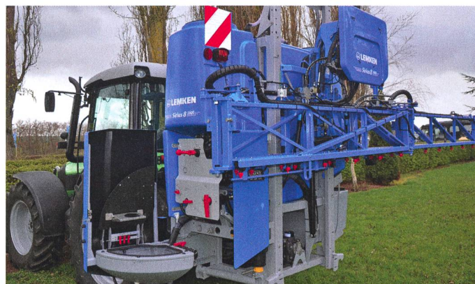
Le Sirius 8 se distingue de la série 10 en premier lieu par son degré d'automatisation – visible sur la photo – et sa rampe de pulvérisation conventionnelle, bien qu'optimisée.
