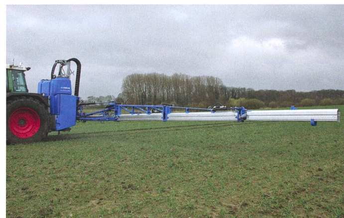
Le profil alu donne une grande stabilité et protège de manière optimale les quintuples corps de buse à enclenchement individuel.
