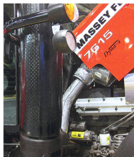
Le catalyseur d'oxydation diesel (DOC) prend place sous le capot moteur.
