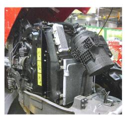
Le pack de refroidissement et le filtre à air du MF 7600 sont redessinés pour en favoriser l'accès depuis l'avant du tracteur. Un système Venturi préfiltre 90 % des poussières selon le fabricant.
