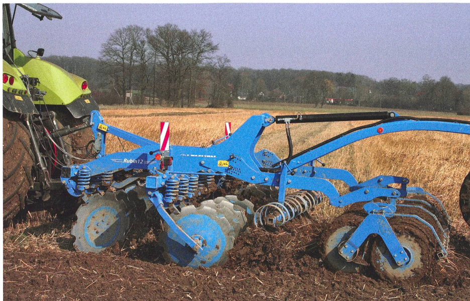
Avec une profondeur de travail de 20 cm, la Rubin doit être tractée par un tracteur d'au moins 150 kW. (Photo : Lemken)
