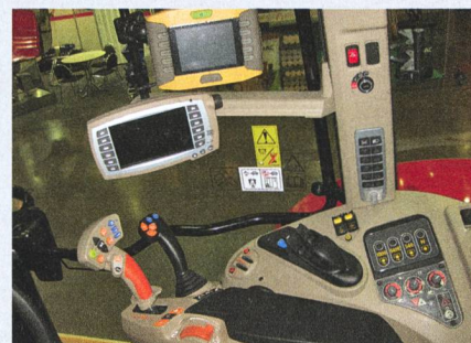
Sur la finition haut de gamme Exclusive, un accoudoir associe le levier d'avancement Multipad et le joystick de commande électrique des distributeurs.
