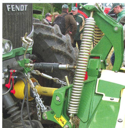
Nouveau dispositif d'attelage des faucheuses frontales avec prétension hydraulique des ressorts de décharge en option.
