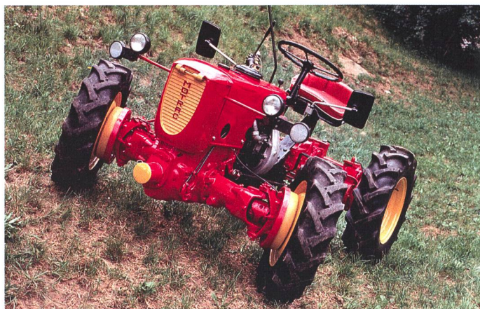
A partir du monoaxe, Motrac a développé un petit tracteur avec traction sur les quatre roues orientables et à freinage individuel.
