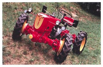
A partir du monoaxe, Motrac a développé un petit tracteur avec traction sur les quatre roues orientables et à freinage individuel.
