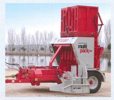
Le fabricant espagnol « Arcusin » expose, à côté de chargeuses à grosses balles la lieuse « Multipack B14 ». Cette machine fonctionne selon un processus dissocié, c'est-à-dire que les petites balles sont d'abord déposées sur le sol par la presse, puis attachées ensemble par la lieuse lors d'une opération séparée. L'avantage de cette machine, avec chambre de liage verticale, consiste en sa structure relativement simple et la bonne visibilité du conducteur sur la machine.
