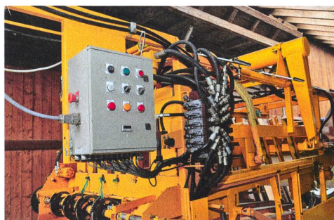
Le dispositif de commande automatique de la machine se trouve dans un boîtier à côté du bloc de commande hydraulique. (Photo: Ruedi Burkhalter)
