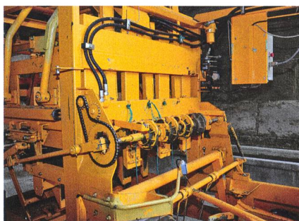
Les quatre noueurs de la lieuse fonctionnent de manière analogue à ceux des presses à grosses balles conventionnelles. (Photo: Ruedi Burkhalter)
