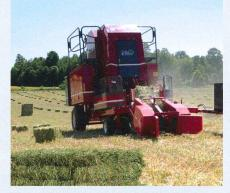
Le fabricant canadien Bale Baron propose cette machine directement attelée à la presse ou prenant les balles du sol, ceci en trois variantes de 21, 18 ou 9 balles de différentes tailles. Ces machines fonctionnent avec une chambre de liage horizontale et travaillent avec de la ficelle et des noueurs Hesston. Dans les trois variantes, trois balles sont empilées les unes sur les autres:
