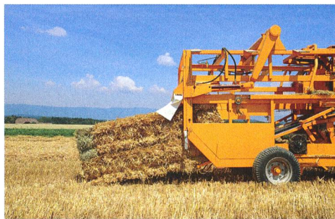
Le paquet de balles glisse hors de la chambre de pressage sans qu'il faille s'arrêter. (Photo: Heinz Röthlisberger)
