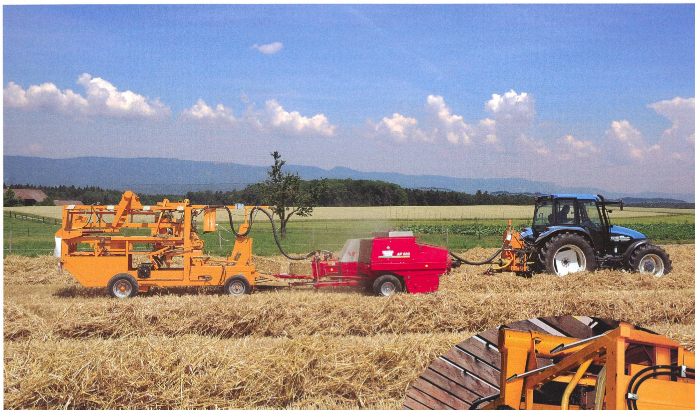
Urs Ruchti attèle la lieuse de balles directement derrière la presse. L'attelage mesure alors plus de 16 m. La pompe hydraulique se trouve entre le tracteur et la presse. (Photo : Heinz Röthlisberger, Schweizer Bauer)
