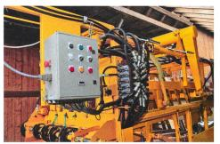
Le dispositif de commande automatique de la machine se trouve dans un boîtier à côté du bloc de commande hydraulique.
