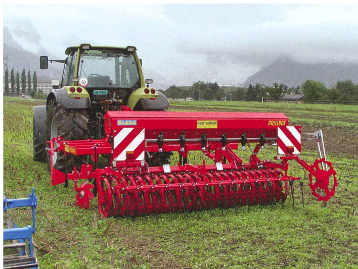
Système de semis simple à monter sur outil rigide. (Photo d'usine Einböck)
