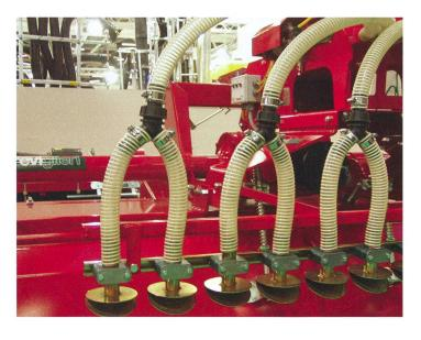
Au moyen de semoirs fonctionnant selon le principe «Krummenacher», la semence est dosée mécaniquement, transportée de manière pneumatique et distribuée par déflecteur.
