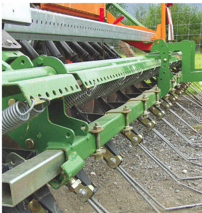
Semis en ligne: bien surveiller la profondeur et régler la herse du semoir vers le bas. (Photos: Ruedi Hunger)
