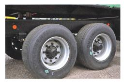
Respecter la pression de gonflage et la capacité de charge indiquées par le constructeur du pneumatique est déterminant pour sa durée de vie. Après une longue période d'inutilisation, les remorques feront l'objet d'un contrôle attentif.
