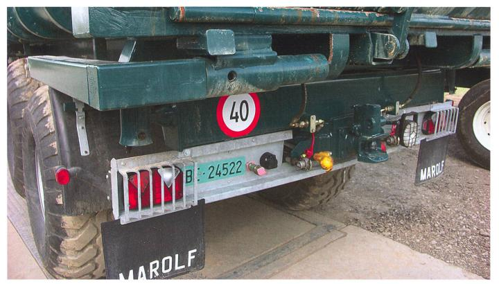
Les installations d'éclairage et la signalisation des remorques de transport doivent être contrôlées régulièrement.
