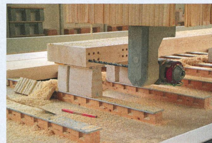
Une machine CNC fore des trous dans les pièces de bois, qui seront ensuite assemblées au moyen de tiges filetées en acier.
