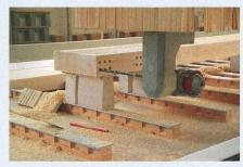
Une machine CNC fore des trous dans les pièces de bois, qui seront ensuite assemblées au moyen de tiges filetées en acier.
