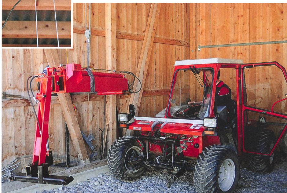
Découplé, le bras télescopique ne prend qu'une place minime dans la remise. Les opérations de montage-démontage se font sans outil, en 10 à 15 minutes.
