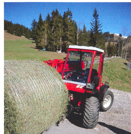
Grâce à sa direction sur quatre roues, le Metrac est très maniable.
