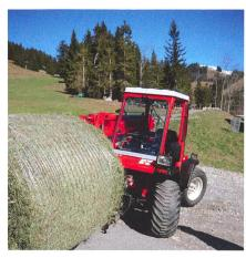
Grâce à sa direction sur quatre roues, le Metrac est très maniable.
