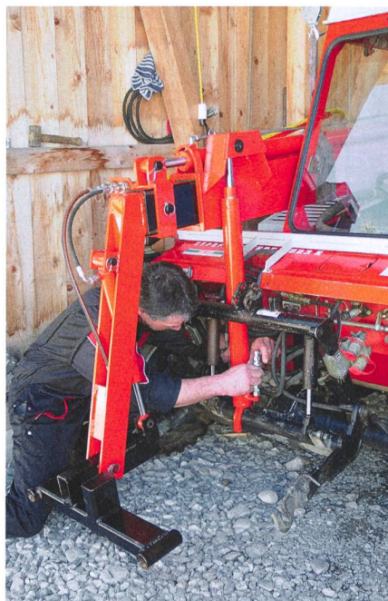
Un tuyau a été tiré vers l'avant pour brancher le vérin.
