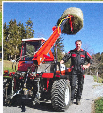
Rolf Kunz a conçu et réalisé son bras télescopique de A à Z.
