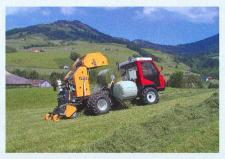
La récolte d'ensilage en balles rondes s'est aussi développée en zone de montagne. Elle permet de récolter du fourrage avec moins de main d'œuvre. Cependant, on n'y trouve souvent que des véhicules légers adaptés à la pente, comme les faucheuses à deux essieux et les transporteurs; ils ne peuvent déplacer des balles d'ensilage de format standard que sous conditions.
