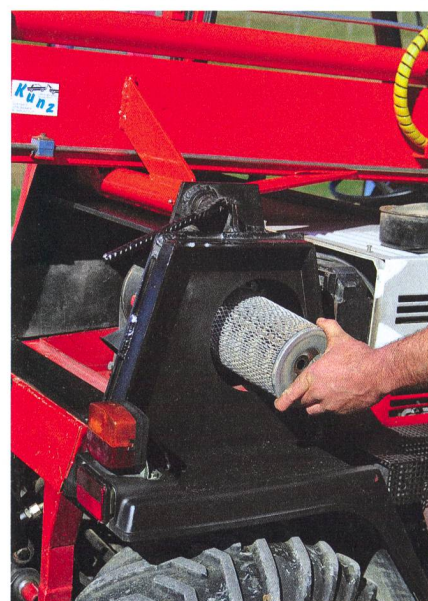
Le bras est monté sur un cadre disposant d'une ouverture pour le filtre à air.
