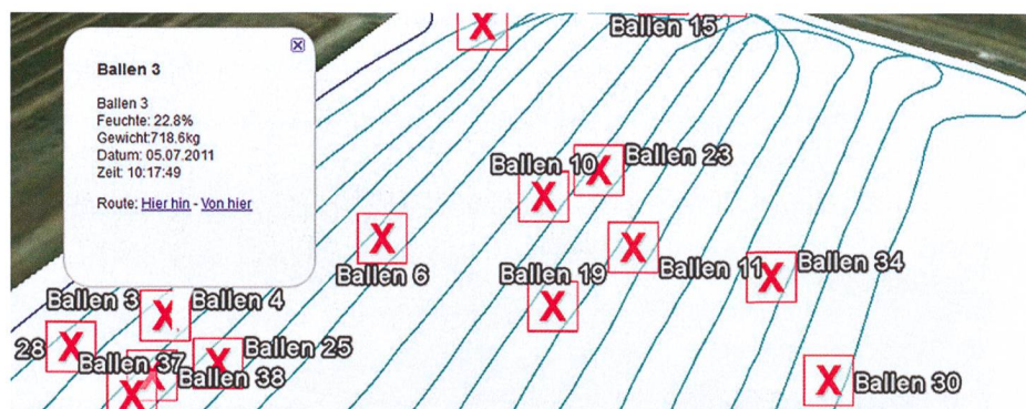
Le coordinateur des opérations peut voir ici d'un seul coup d'œil où les balles ont été déposées. Grâce aux données de poids, le transport peut s'organiser de manière optimale.
