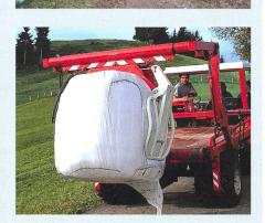
tracteur très léger. Mais impossible de charger ou décharger une remorque. Le Mulaki (photo du bas) est une autre possibilité. Ce dispositif s'arrime sur un transporteur; il dispose d'un bras de levage qui peut charger sur le pont aussi bien des balles d'ensilage que d'autres objets pesants, caisses ou bennes par exemple.
