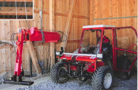
Découplé, le bras téléscopique ne prend qu'une place minime dans la remise. Les opérations de montage-démontage se font sans outil, en 10 à 15 minutes.
