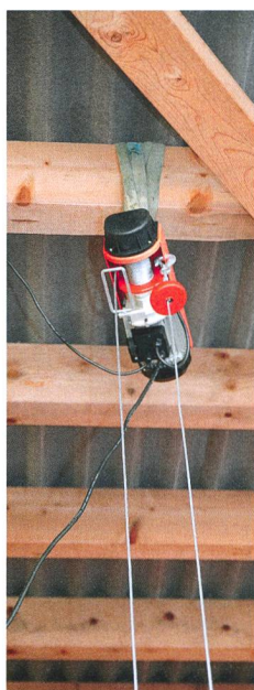
Un palan électrique permet de soulever le bras télescopique.
