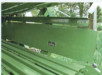
Grâce à des détecteurs, tel ce capteur d'humidité dans le canal d'alimentation, le coordinateur des opérations est à même de contrôler la qualité du travail.
