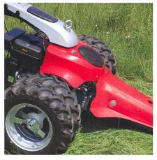
Les roues jumelées élargissent la voie et augmentent la surface de contact au sol. De plus, l'on peut rouler sans problème sur les routes et les chemins.
