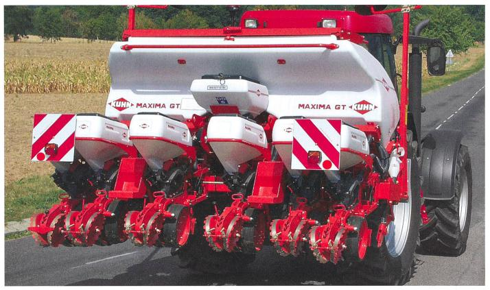
Les outils sur des véhicules agricoles sont autorisés jusqu'à une largeur de 3,5 m. La largeur est indiquée par des panneaux marqueurs rouge/blanc. Lorsque l'éclairage est caché, une installation équivalente de remplacement doit être apposée.
