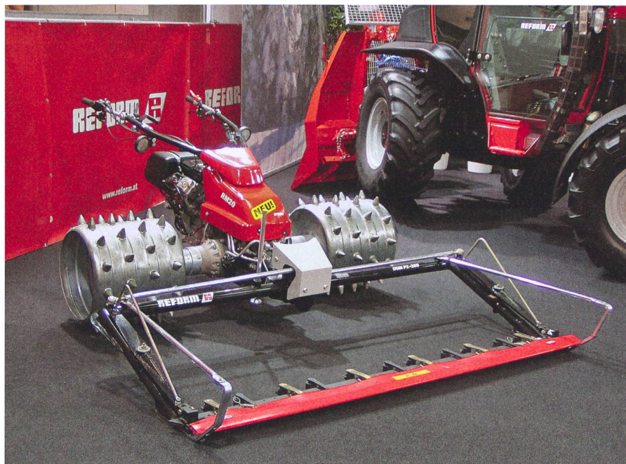
Les rouleaux à crampons intégraux ne sont utilisables que sur terrain naturel, voire quelque peu sur des chemins au revêtement pas trop compacté.
