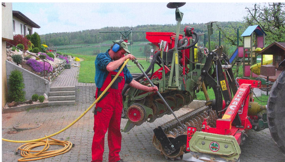
Lors de travaux de nettoyage ou de maintenance, un arrêt de sécurité doit être observé. On interviendra sous une machine qu'après l'avoir assurée contre une chute éventuelle.
