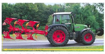
La longueur des véhicules agricoles avec des outils portés peut atteindre au maximum 12 m. Les outils supplémentaires peuvent atteindre une distance de 4 m vers l'avant, mesurés depuis le milieu du volant. Des rétroviseurs à vision latérale sont nécessaires lorsque la distance est de plus de 3 m. (Photos SPAA)
