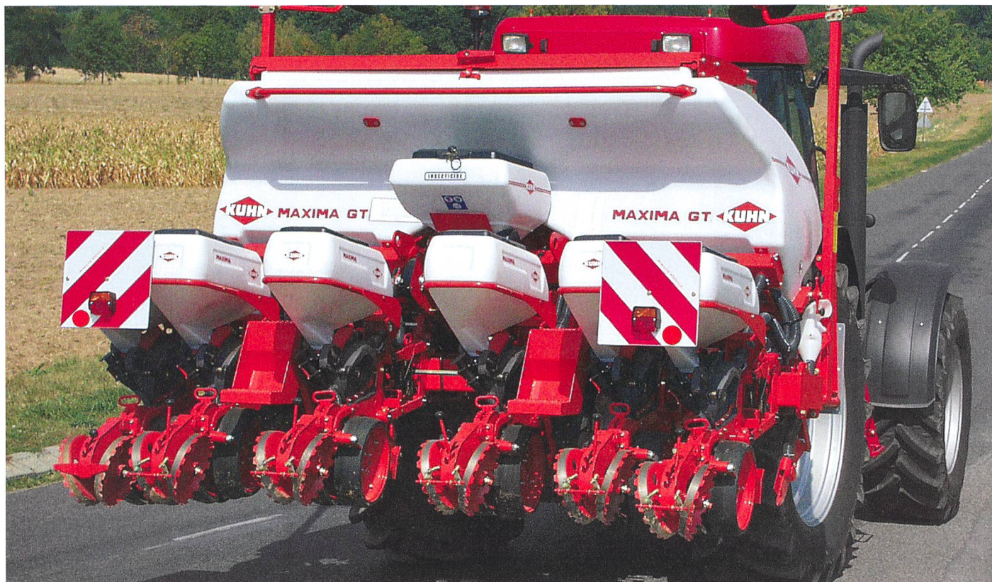
Les outils sur des véhicules agricoles sont autorisés jusqu'à une largeur de 3,5 m. La largeur est indiquée par des panneaux marqueurs rouge/blanc. Lorsque l'éclairage est caché, une installation équivalente de remplacement doit être apposée.
