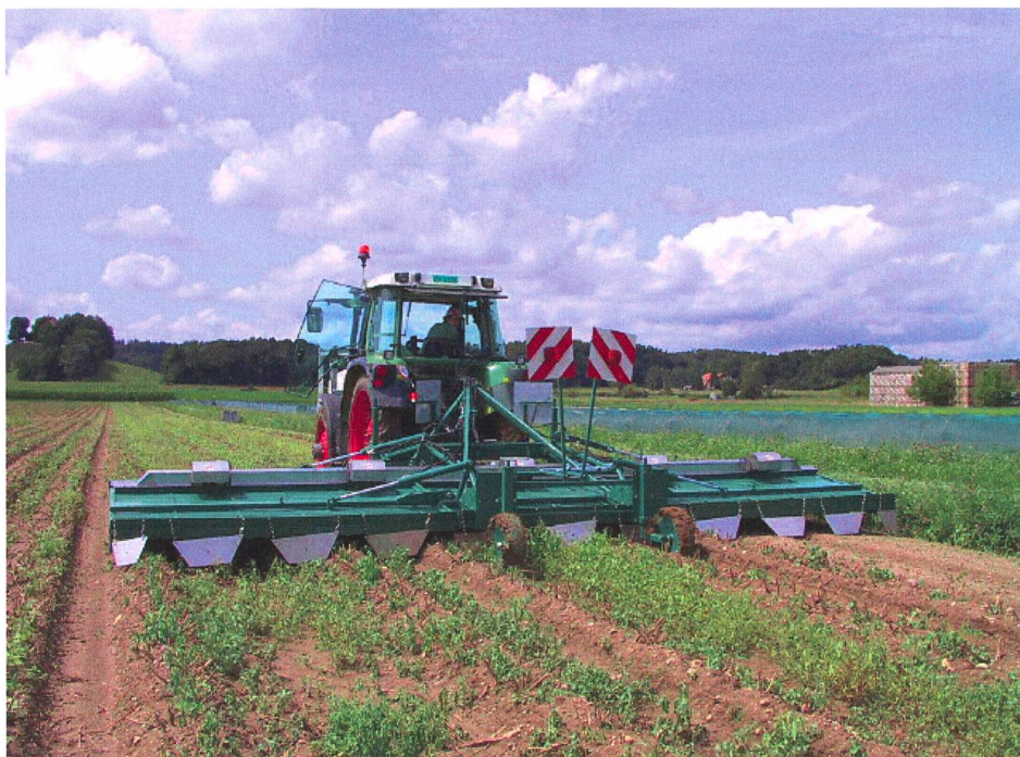
Défanage de pommes de terre avec un modèle «STfFG7.5LG» de Schaffner Terra-Tech SA, Oensingen. Largeur 7,5 m, consommation de gaz 100 kg/h, vitesse 2-5 km/h, poids 1400 kg.
