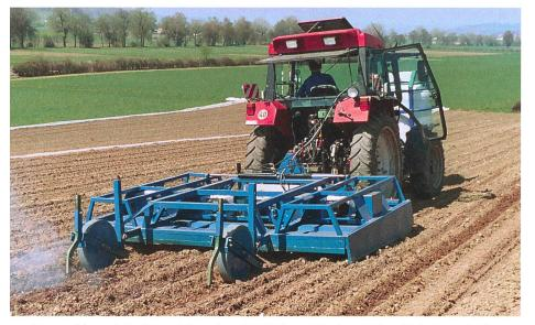
En maraîchage, le traitement thermique intégral en prélevée est très utilisé, en particulier sur les carottes. Appareil de désherbage «StfFG1.5/3.0SG» (Schaffner Terra Tech SA, Oensingen). (Photo: LDD)
