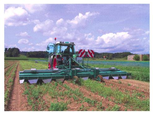
Défanage de pommes de terre avec un modèle « STfFG7.5LG » de Schaffner Terra-Tech SA, Oensingen. Largeur 7,5 m, consommation de gaz 100 kg/h, vitesse 2-5 km/h, poids 1400 kg. (Photo: LDD)
