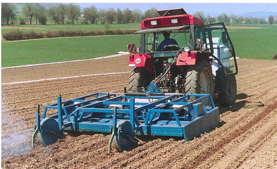
En maraîchage, le traitement thermique intégral en prélevée est très utilisé, en particulier sur les carottes. Appareil de désherbage « StffG1.5/3.0SG » (Schaffner Terra Tech SA, Oensingen).
