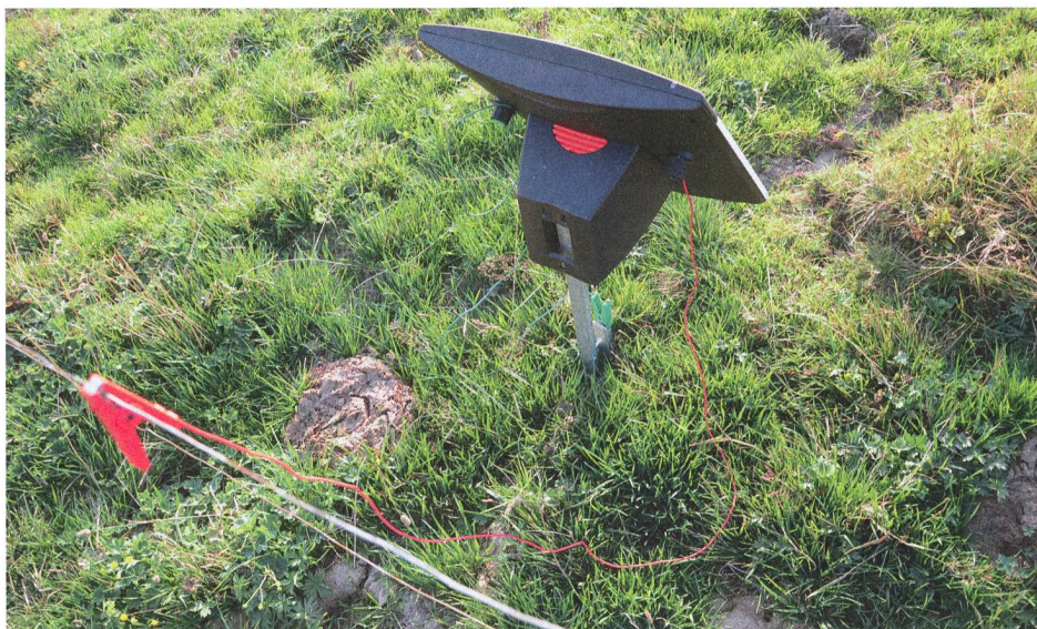
Exemple d'une installation en îlot avec pile: un garde-bétail avec son panneau solaire et sa batterie. L'accumulateur génère des coûts qui peuvent atteindre 40 % de l'investissement (remplacement périodique indispensable). (Photos: Ruedi Hunger)
