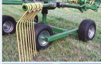
Les andaineurs à toupie repoussent le fourrage sur le sol à une vitesse de 6 à 7,5 m/s. La forme des dents diffère d'un constructeur à l'autre.
