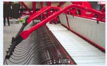
Les andaineurs à tapis prélèvent le fourrage avec un pick-up et le transportent avec un tapis à gauche ou à droite. Un dispositif de maintien au sol assure un prélèvement propre du fourrage.
