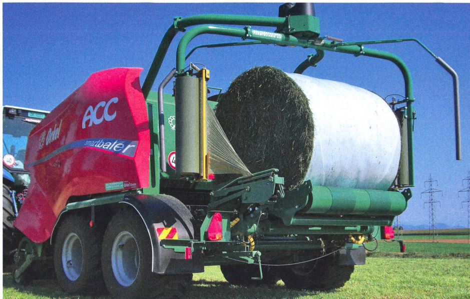
Avec son «HiQ Smartbaler», Orkel propose la première et la seule combinaison capable de lier les balles avec un filet ou une feuille «manteau».
