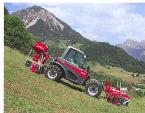
Dans les pentes, une combinaison d'outils avant et arrière facilite la conduite et nécessite des tracteurs moins puissants.
