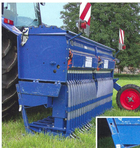
▲ L'Herbamat de Köckerling ouvre le sol, puis referme les rainures après le dépôt des graines.
