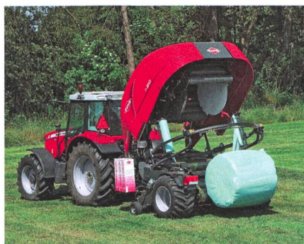
La combinaison « IBIO » de Kuhn est la seule qui enrubanne également dans la chambre de pressage.
