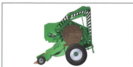
La chambre semi-variable de Krone travaille selon le principe de la chambre fixe. Au départ (à gauche), la chambre est angulaire. Après avoir atteint le format normal (au milieu), l'organe de pressage se lève au-dessus des roulettes de guidage, ce qui permet un diamètre plus grand (à droite).
