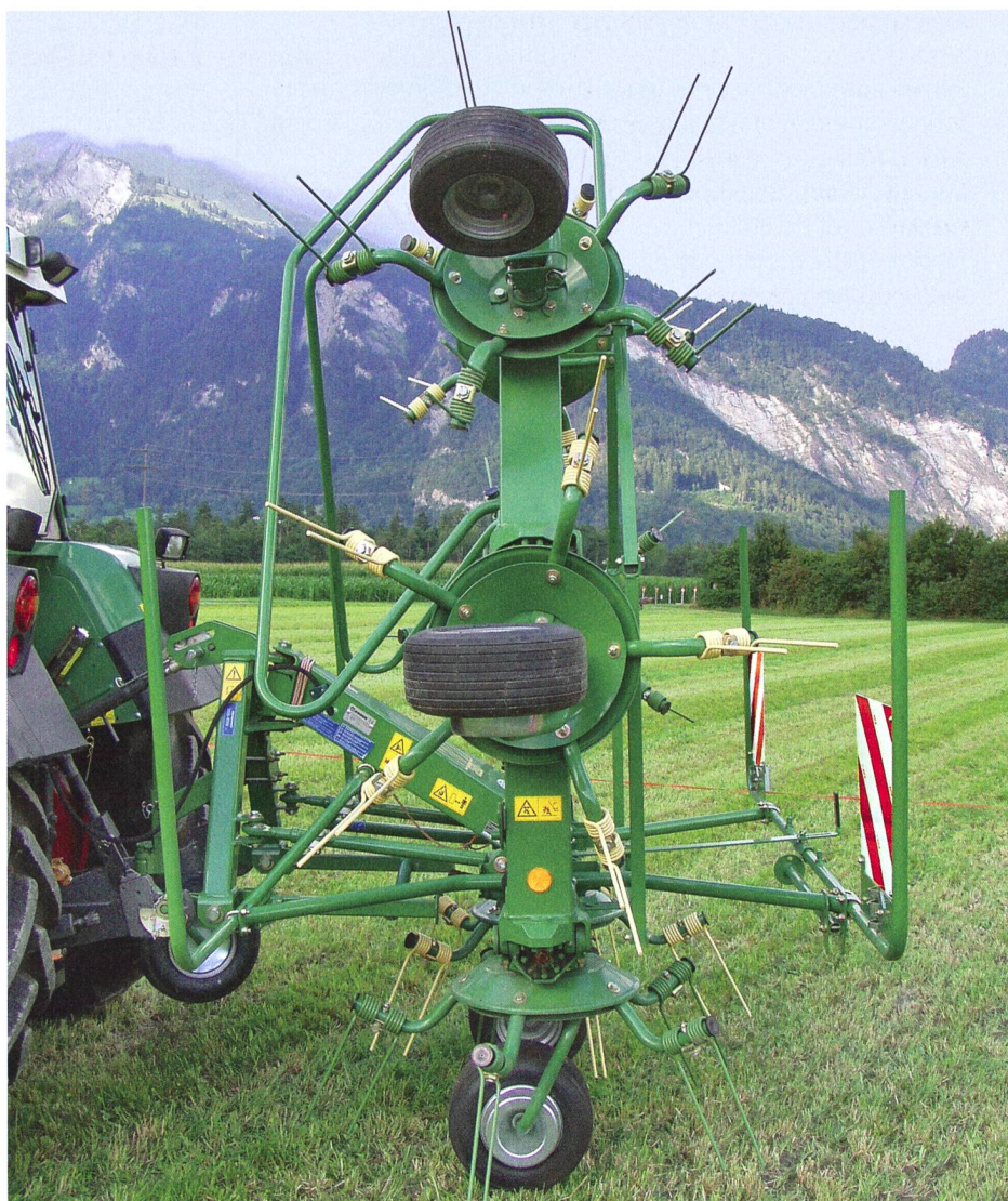
Krone différencie les dents tournant à droite et à gauche au moyen de couleurs diverses.
