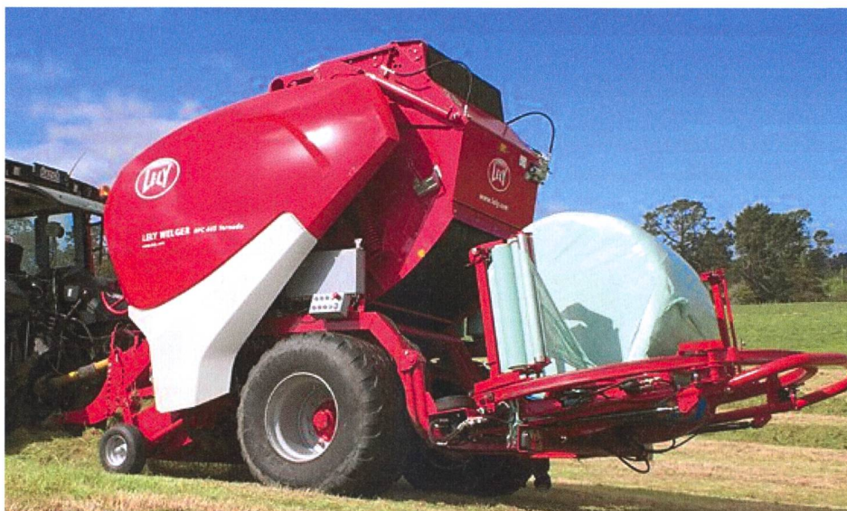
La « RPC 445 Tornado » von Lely Welger est une combinaison presse-enrubanneuse unique avec sa chambre variable, son système CPS et sa table d'enrubannage relevable.
