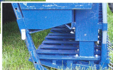
▲ L'Herbamat de Köckerling ouvre le sol, puis referme les rainures après le dépôt des graines.
