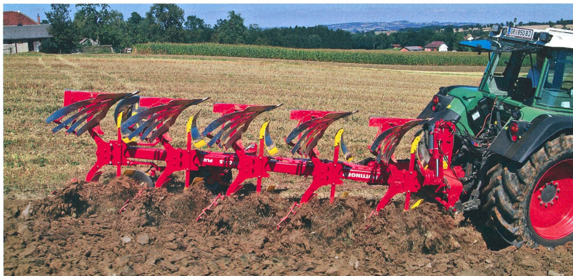
Charrues d'aujourd'hui : une Pöttinger-Servo 5 socs. (Photo d'usine)
