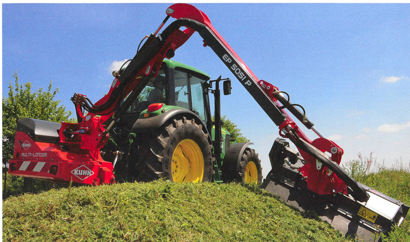
Le travail en position latérale met très fortement à contribution les éléments de fixation au tracteur.
