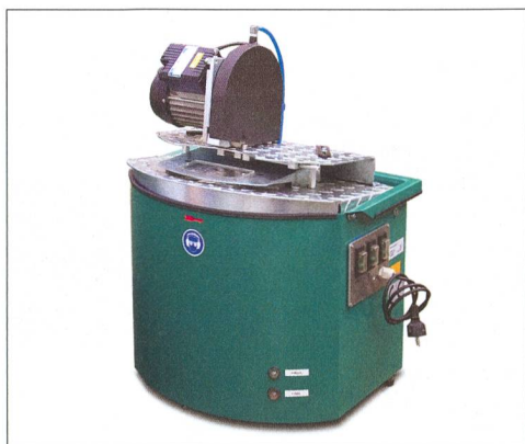
L'affûteuse « MNSG » de Lechner est le seul capable d'aiguiser les lames dentelées.
