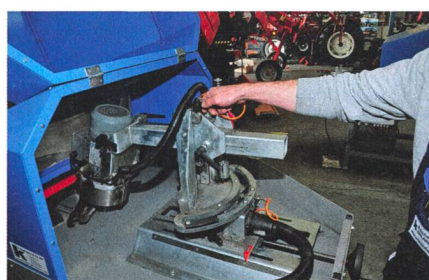
Avec l'automate d'affûtage «Autogrind», chaque couteau est fixé individuellement avec un chablon.
