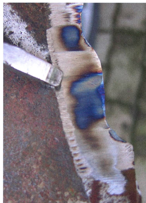
Lors de l'aiguisage à sec, les couteaux s'échauffent et perdent de leur résistance.
