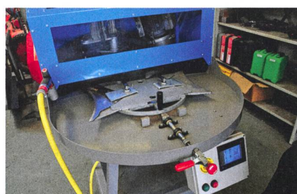
Avec l'automate d'affûtage «Autogrind», chaque couteau est fixé individuellement avec un chablon.
