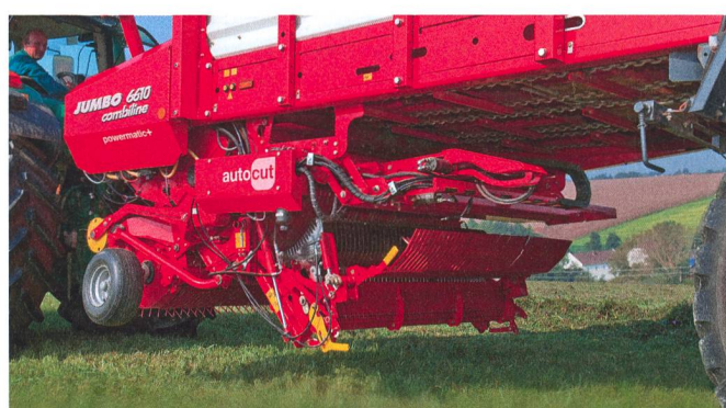
Le système « Auto Cut » de Pöttinger est le seul capable, jusqu'à présent, d'aiguiser les couteaux sans les démonter.
