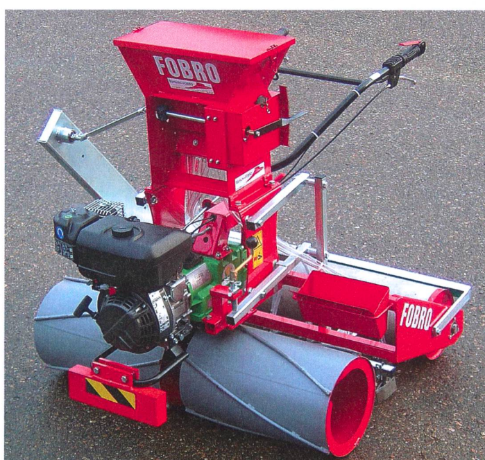
Des barrettes soudées sur les rouleaux moteurs assurent l'adhérence nécessaire.
