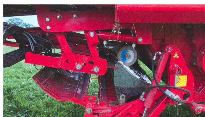
Le système « Auto Cut » de Pöttinger est le seul capable, jusqu'à présent, d'aiguiser les couteaux sans les démonter.
