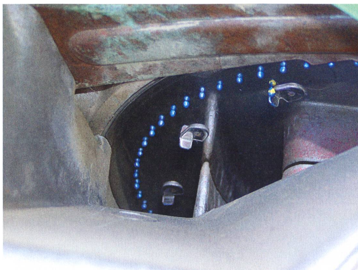
Les graines sont aspirées et maintenues par dépression contre le disque perforé qui tourne dans la trémie. (Photo : Ruedi Hunger)
