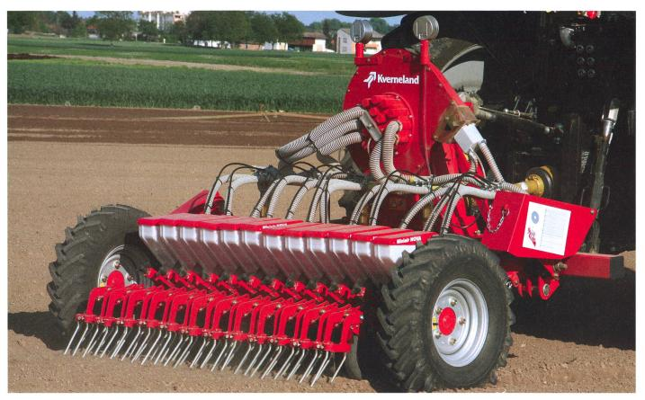
Semoir pneumatique pour légumes, attelé au tracteur Kverneland. (Photo d'usine)
