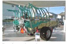
Tonne à pompe à un essieu pour tracteur, d'une capacité de 25 000 litres.
