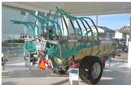
Tonne à pompe à un essieu pour tracteur, d'une capacité de 25 000 litres.
