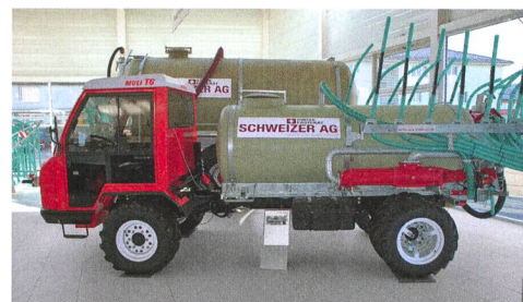
Tonne à pompe pour véhicule porteur, constituée d'une citerne ronde en polyester avec sangles d'arrimage.
