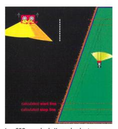
Le «GEOspread» de Kverneland est un système de modulation de largeur GPS avec un réglage du point d'impact online pour épandeur d'engrais. Ainsi, une meilleure précision qu'avec une simple modification de la quantité est obtenue.
