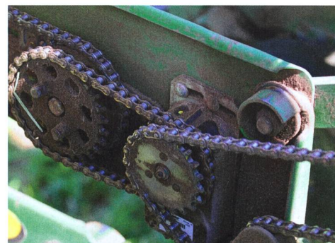
Avec le « Row Command » de John Deere, les lignes de semis sont enclenchées et déclenchées au moyen d'un entraînement à courroie à commande électrique.
