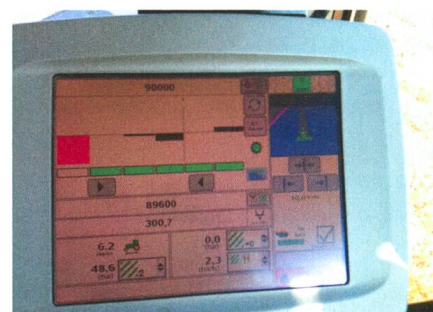
Sur l'écran Greenstar 2600 de John Deere, l'on voit quelles parties de la machine sont enclenchées ou déclenchées.
